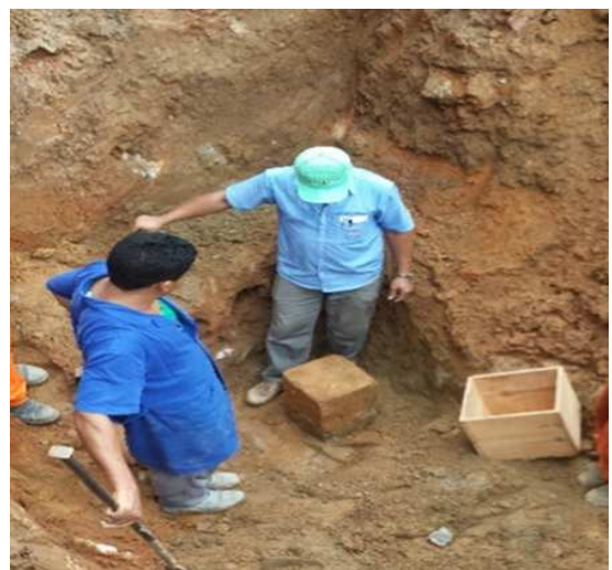
Figura 67 – Detalhe da retirada da amostra indeformada do Solo 2, Prof: 3,00m
