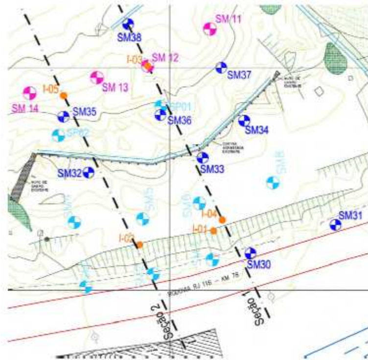
Figura 58 - Inclínômetros e sondagens. (TERRAE, 2014)
