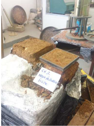
Figura 71 – Amostra sendo preparada para o cisalhamento.
