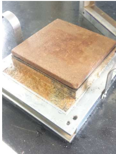
Figura 72 – Corpo de prova saturado já cisalhado.
