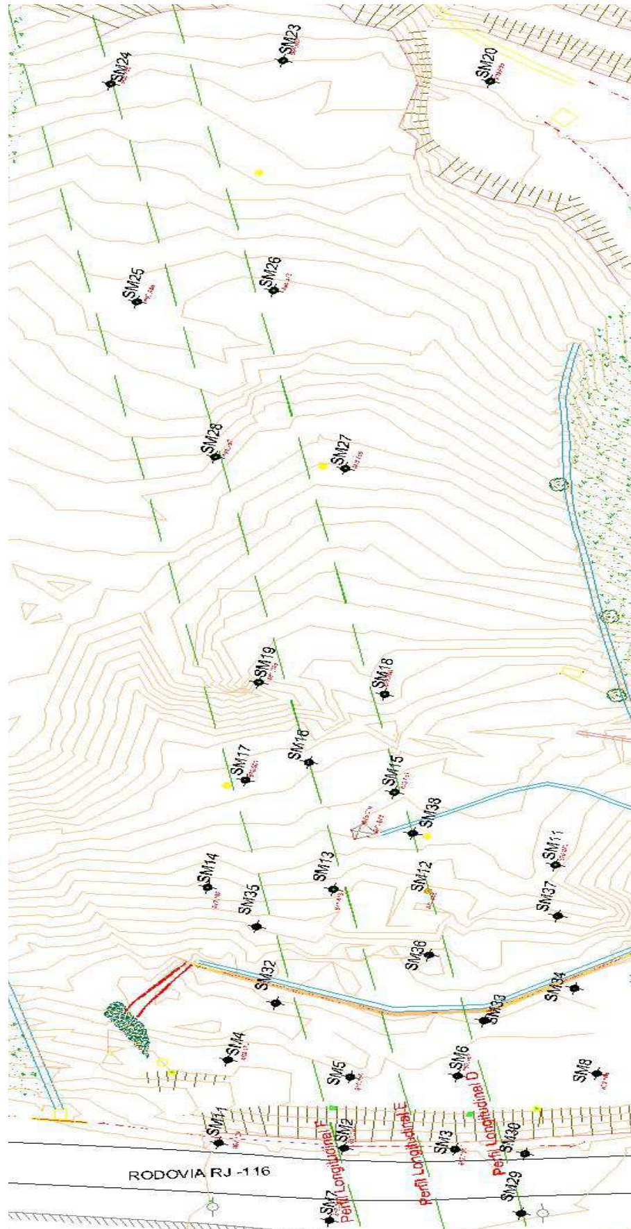
Figura 54 - Localização das sondagens mistas executadas
