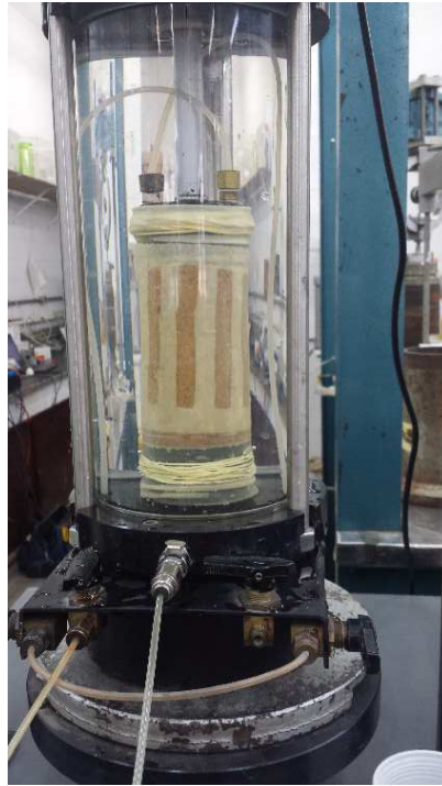
Figura 73 – Corpo de prova no ensaio Triaxial.
