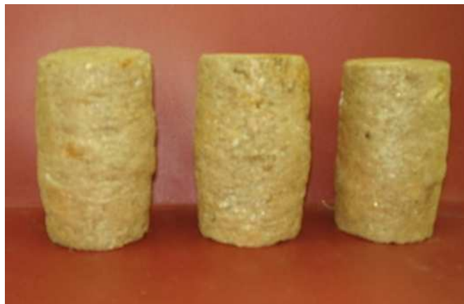
Figura 74 – Corpos de prova após o ensaio Triaxial.
