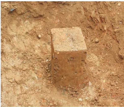
Figura 66 – Detalhe da retirada da amostra indeformada do Solo 1, Prof: 30cm
