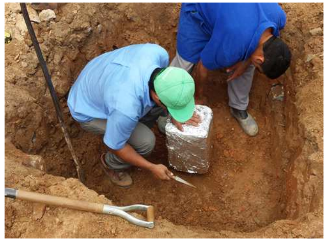
Figura 66 – Detalhe da retirada da amostra indeformada do Solo 1, Prof: 30cm
