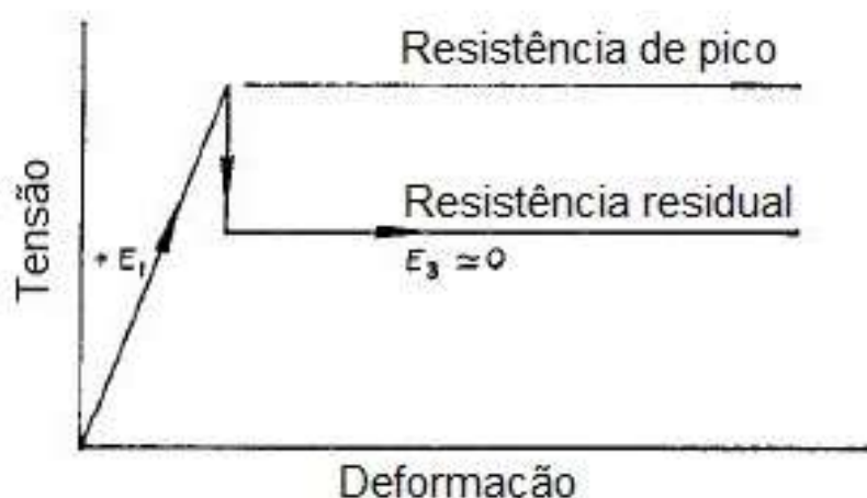
Figura 36 – Diagrama tensão vs. deformação com amolecimento simplificado adotado – Adaptado (Lo e Lee, 1973)
