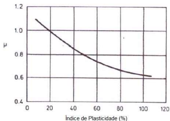
Figura 27 – Fator de Correção da resistência não drenada determinada no ensaio de palheta (Bjerrum, 1972)
