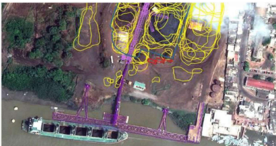
Figura 111 – Foto área do Porto de Santana registrada por Satélite. Em amarelo, a sobreposição de diversas pilhas registradas em fotos tiradas no período entre 04/2011 e 07/2015 (Pacheco e Gerscovich, 2014)
