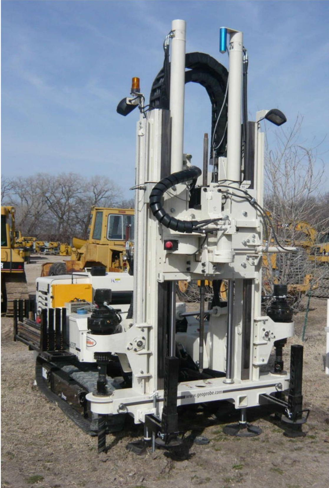
**Figura 35 – Equipamento para cravação da lâmina de DMT e cone do CPTU (Damasco Penna, 2010).**
