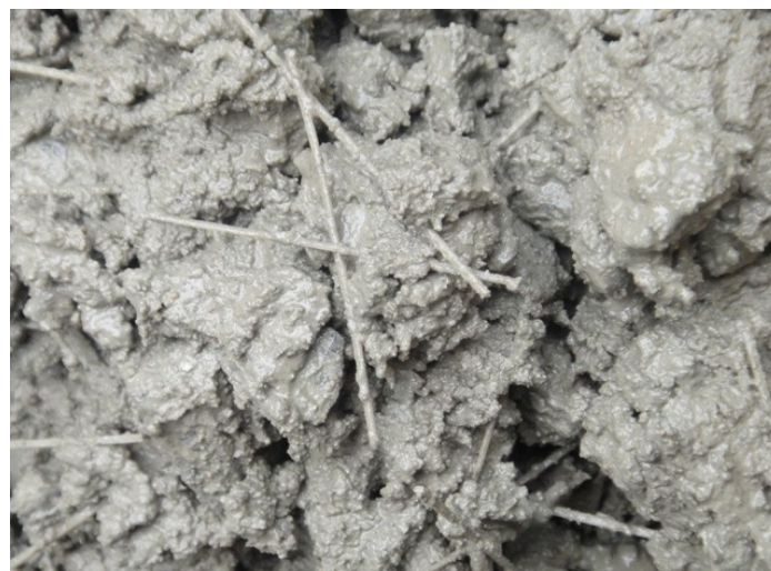
Figura 19 – Detalhe das fibras metálicas misturadas no concreto
