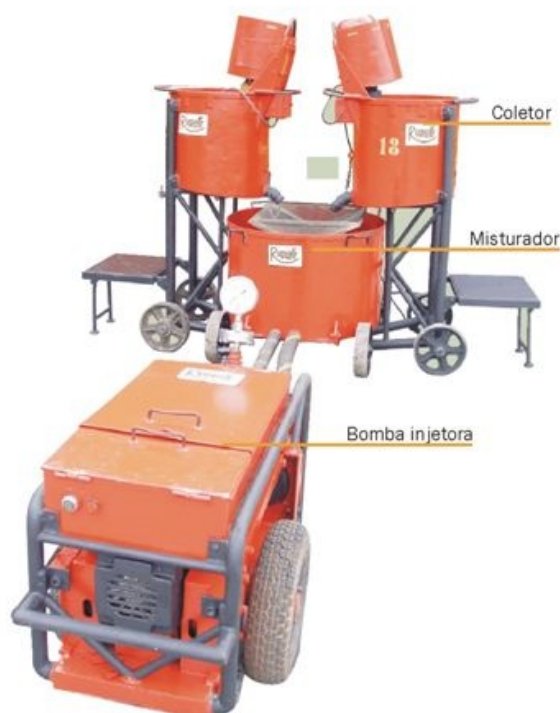
Figura 11 – Detalhe dos equipamentos de injeção: Bomba Injetora e Misturador Helicoidal ( www.rudloff.com.br/concreto-protendidocatalogo-tela.php , 17/08/2015, 15:34)
