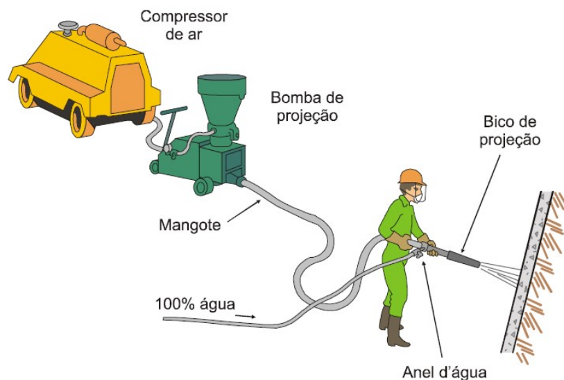
Figura 16 – Execução do concreto projetado
