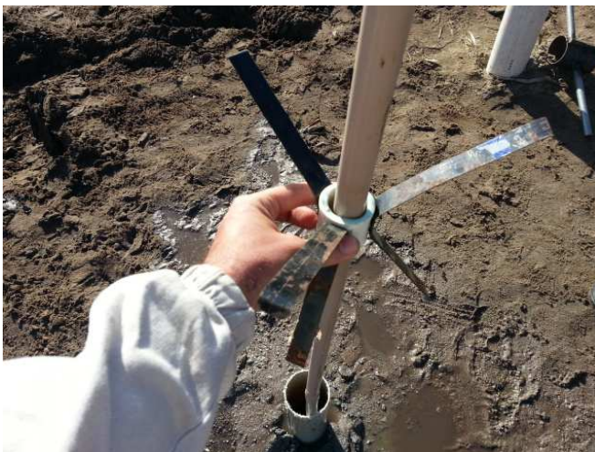
(a) Instalação da aranha magnética.
