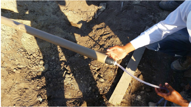
(a) Introdução da sonda no tubo.
