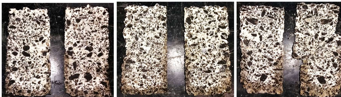
Figura 76 – Distribuição da água no interior dos corpos de prova referente ao concreto com 100% de resíduo de pavimentos asfálticos
