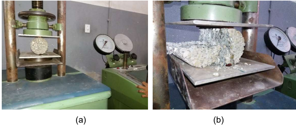
Figura 47 – (a) Ensaio de tração por compressão diametral; (b) Detalhe da ruptura.
