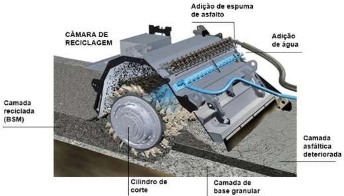
Figura 13 - Detalhe da reciclagem a frio com espuma de asfalto (Disponível em http://asfaltodequalidade.blogspot.com.br acessado em 14/02/2017)
