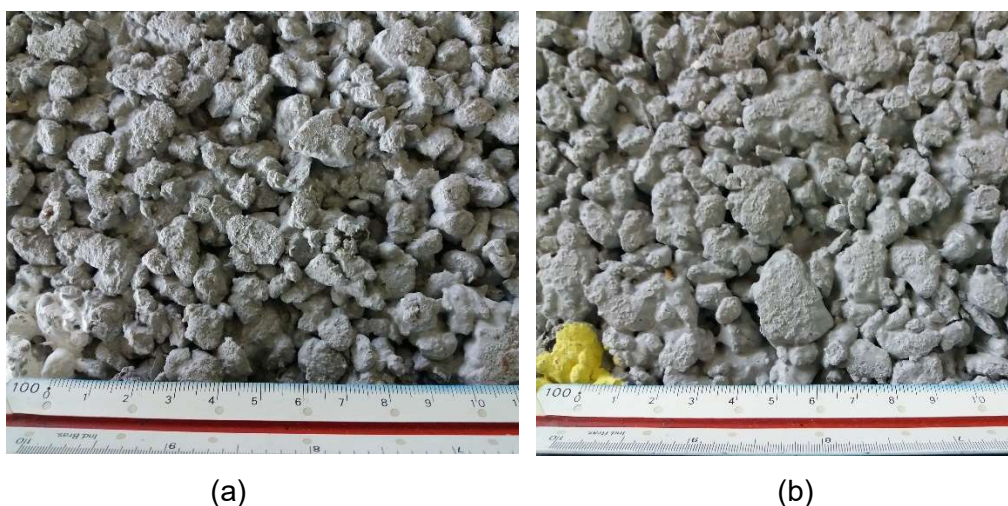
Figura 68 – Aspecto visual da placa (a) concreto referência; (b) 10% resíduo
