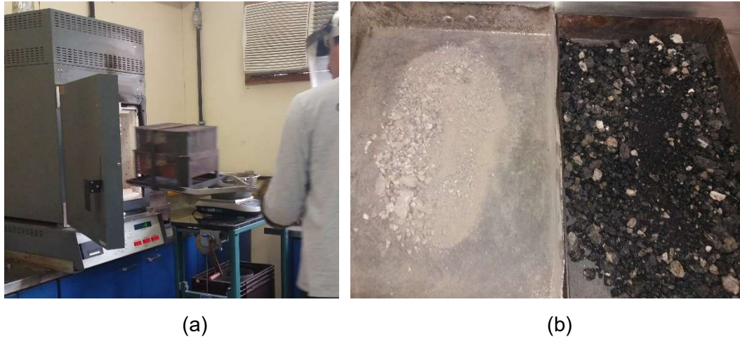
Figura 24 – (a) Processo de extração do CAP; (b) Comparação entre amostras
