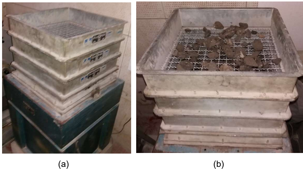
Figura 19 – (a) Peneirador mecânico; (b) Peneiramento do resíduo de pavimentos asfálticos
