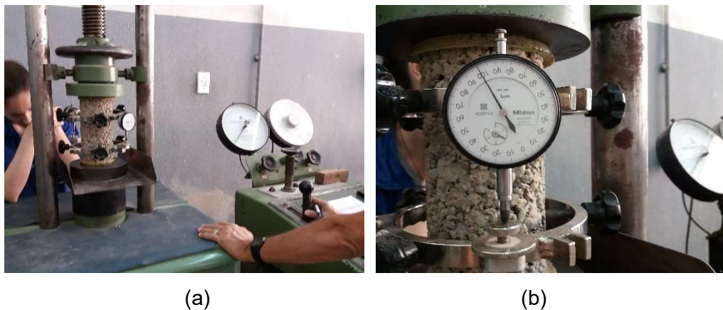
Figura 45 – Concreto 100% resíduo. (a) Ensaio de módulo de deformação; (b) Detalhe do relógio comparador.
