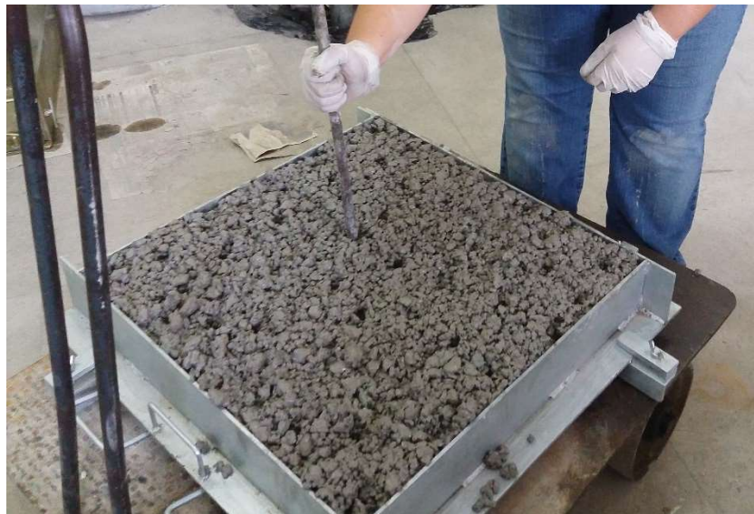
Figura 36 – Compactação manual da placa
