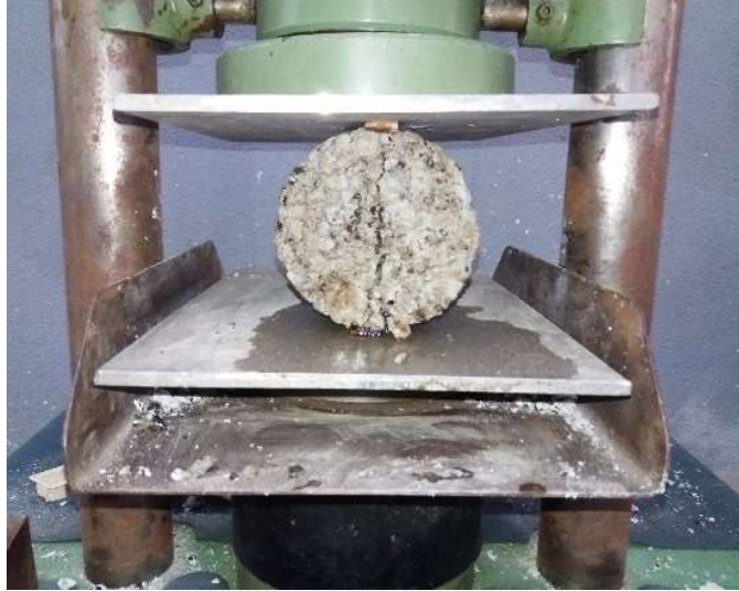
Figura 51 – Ruptura diametral do CP
