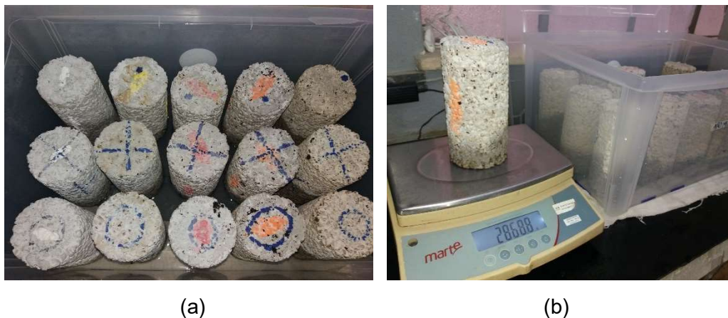
Figura 50 – Ensaio de capilaridade. (a) Processo de imersão parcial; (b) Pesagem.
