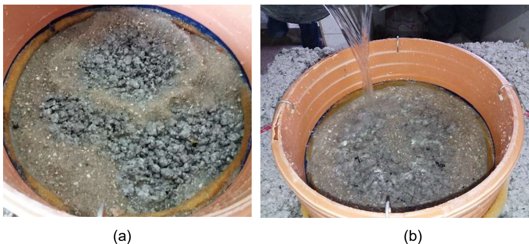
Figura 56 – (a) Detalhe do efeito de confinamento; (b) Despejo circular e contínuo.
