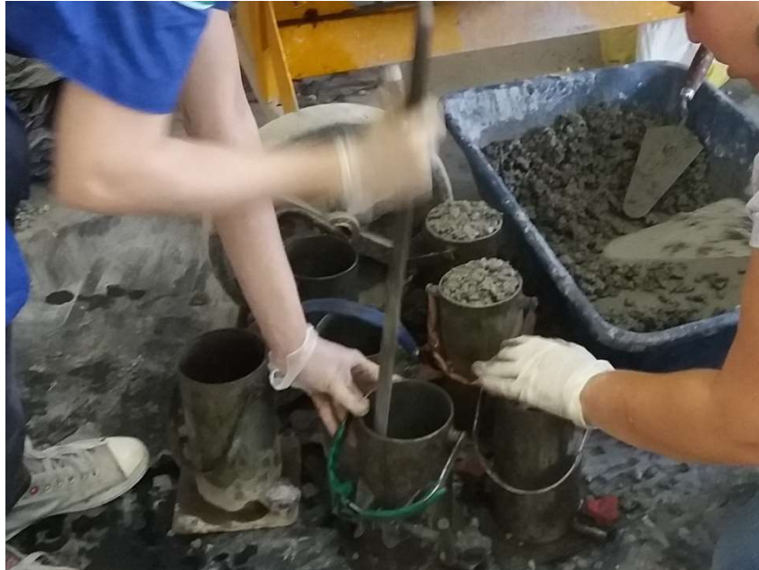
Figura 34 – Compactação manual dos corpos de prova cilíndricos
