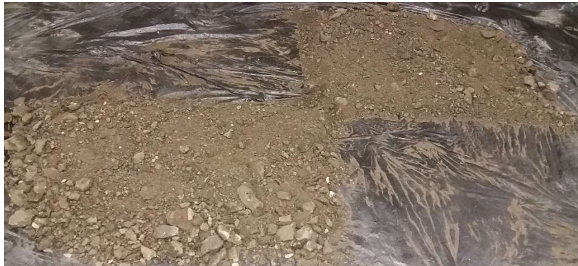
Figura 16 – Redução da amostra (ABNT NBR NM27, 2001)
