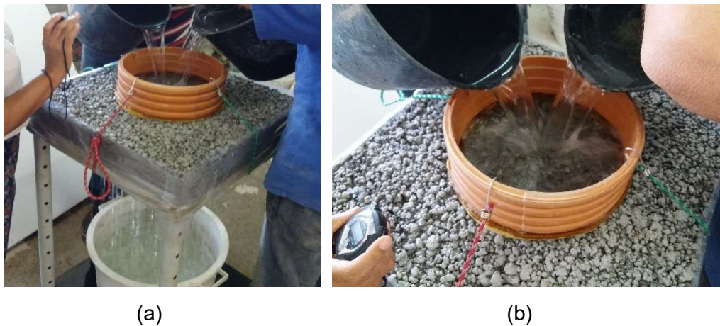
Figura 52 – Concreto 100% resíduo. (a) Pré-molhagem na posição central; (b) Detalhe.
