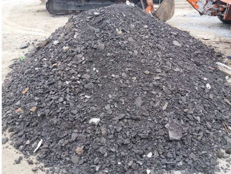
Figura 15 – Resíduo de pavimentos asfálticos
