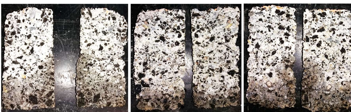
Figura 75 – Distribuição da água no interior dos corpos de prova referente ao concreto com 50% de resíduo de pavimentos asfálticos
