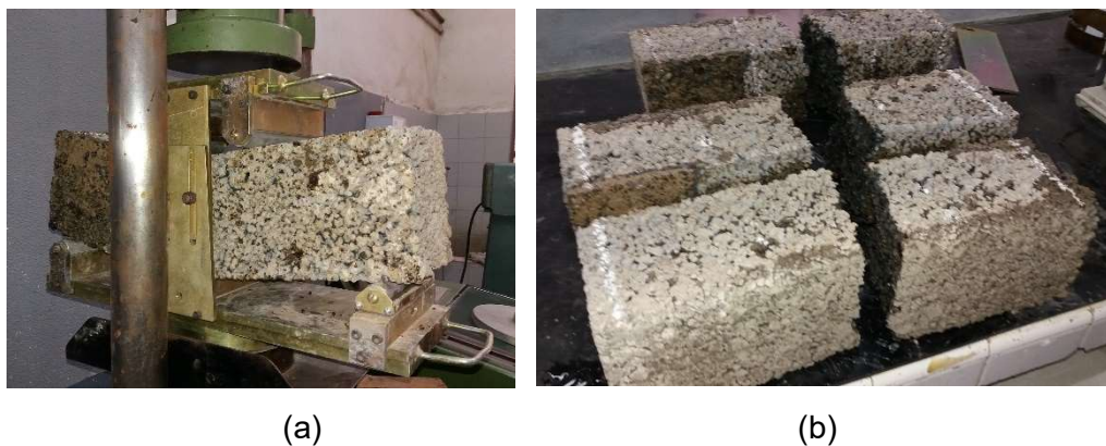
Figura 46 – Concreto 100% resíduo. (a) Ensaio de tração na flexão; (b) Prismas rompidos.
