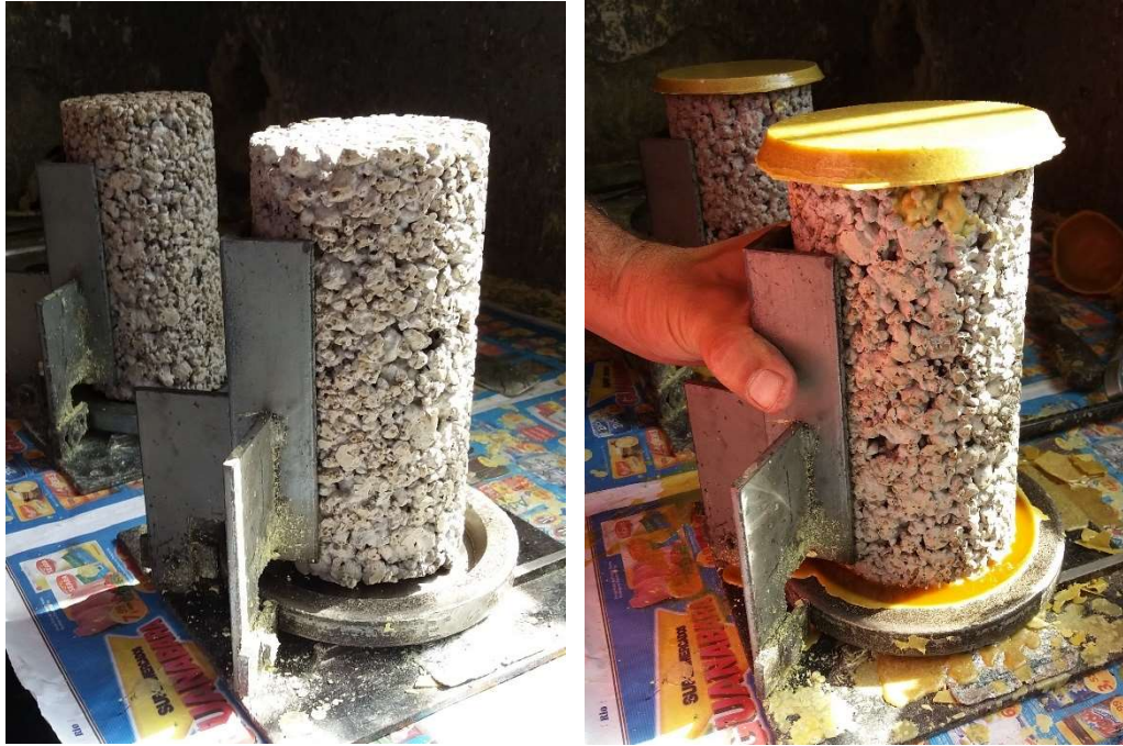
Figura 42 – (a) CP no molde; (b) Capeamento com enxofre.
