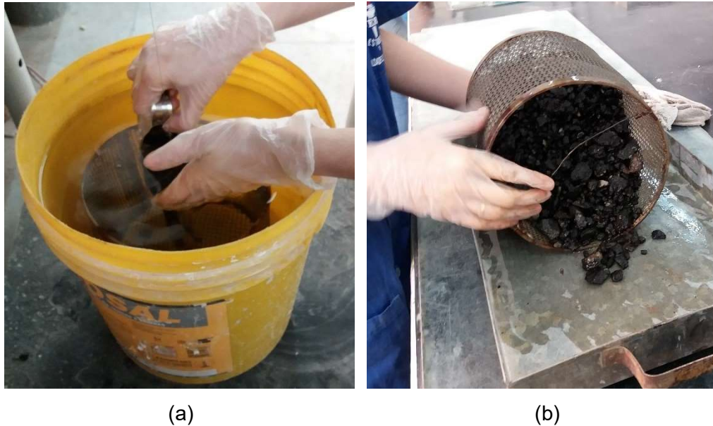
Figura 23 – Ensaio para determinação da massa específica dos agregados graúdos. (a) Massa imersa; (b) Remoção dos agregados para secagem à estufa.
