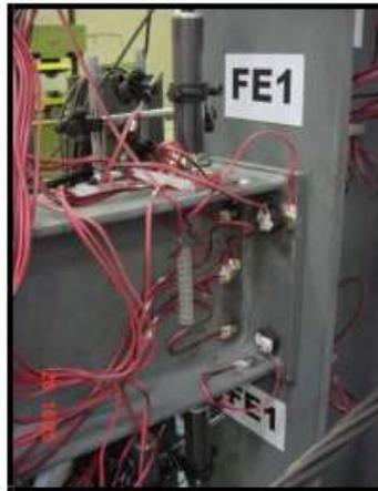
Figura 18 – Ligação ensaiada com placa de extremidade ajustada [30]
