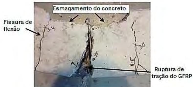
**Figura 24 – Ruptura equilibrada.**
