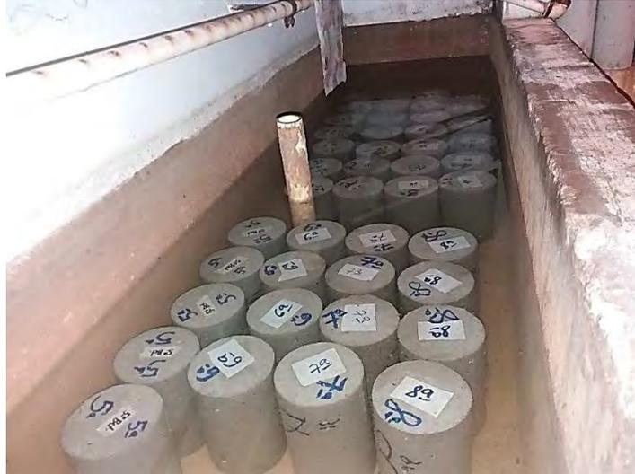
**Figura 38 – Câmara úmida.**
