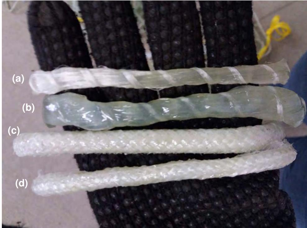
**Figura 29 - Tipos de estribos utilizados: (a) enrolado com  $\varnothing$  6,3 mm; (b) enrolado com  $\varnothing$  8,2 mm; (c) trançado com  $\varnothing$  9,6 mm; e (d) trançado com  $\varnothing$  7,4 mm.**
