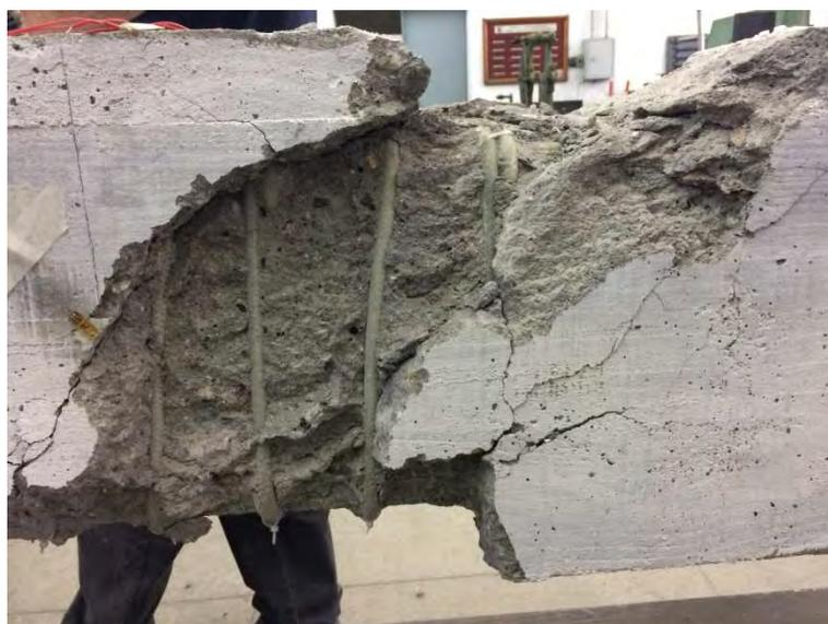
**Figura 67 – Armadura aparentemente íntegra após a ruptura.**
