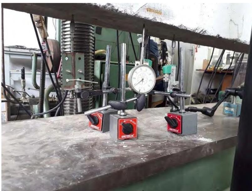
**Figura 54 – Deflectômetros e relógio analógico instalados.**
