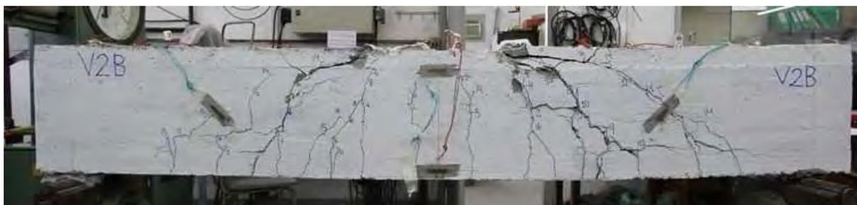
Figura 64 – Padrão de fissuração na ruptura – V2B.
