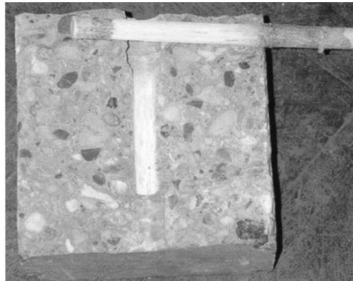
**Figura 11 – barra de fibra de vidro após o teste de arrancamento [20]**
