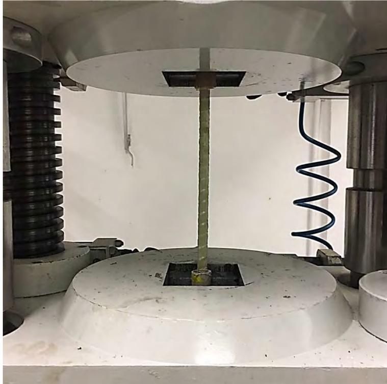
**Figura 41 – Máquina universal para ensaio de tração.**
