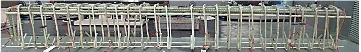
Figura 33 – Armadura da viga V2A.
