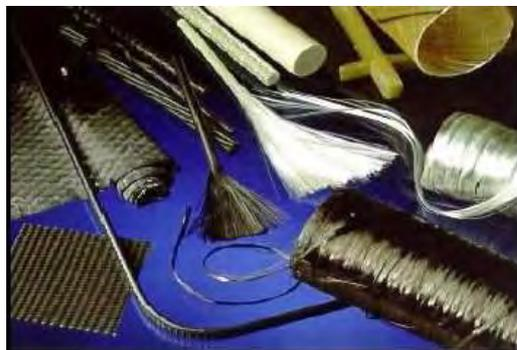
**Figura 3 - Vários tipos e formas de compósitos de FRP usados na indústria da construção[10].**
