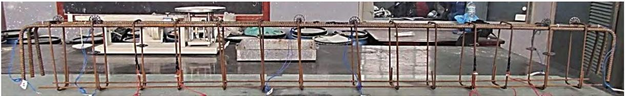
**Figura 35 – Armadura da viga VR1.**
