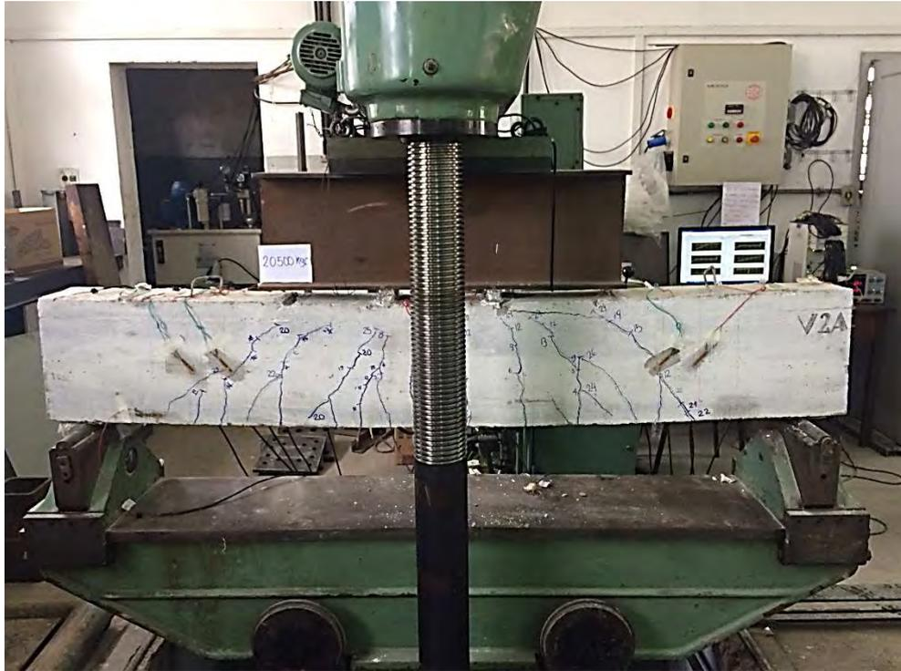
Figura 27 – Modelo de carregamento para ensaio de flexão em quatro pontos.
