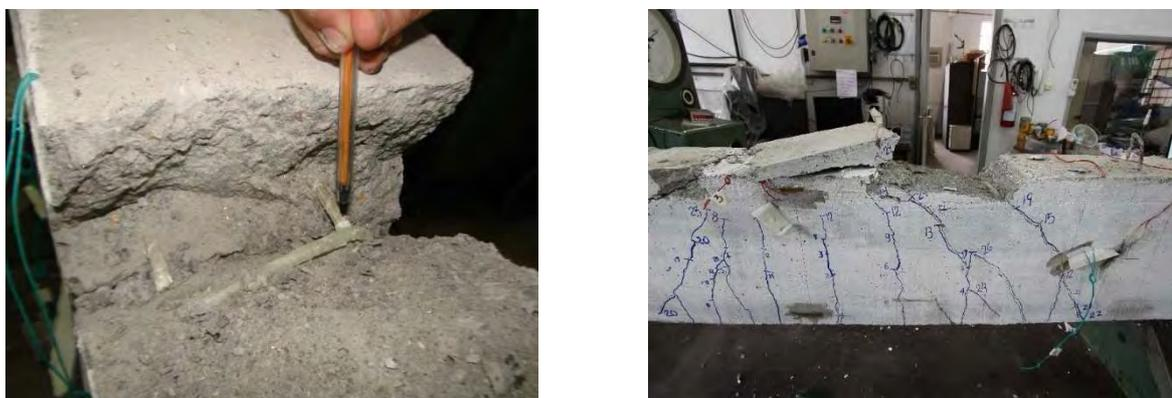
**Figura 68 – Detalhe do deslocamento vertical das armaduras longitudinais superiores (V2A à esquerda e V1B à direita).**
