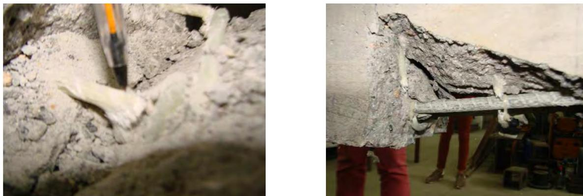
**Figura 66 - Ruptura da armadura longitudinal de compressão (esquerda) e ruptura dos estribos (direita) da viga V1B.**
