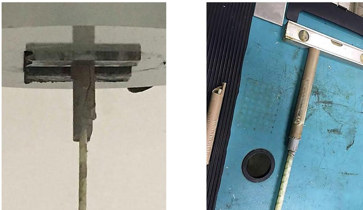
**Figura 42 – Detalhes do escorregamento das barras de GFRP no ensaio de tração.**
