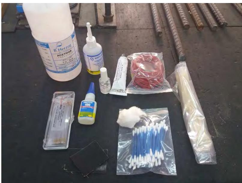
**Figura 51 – Materiais para instrumentação das barras.**
