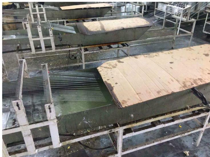
**Figura 6 – Processo de impregnação da resina nas fibras – Foto feita durante visita técnica à Stratus em 07/03/18**
