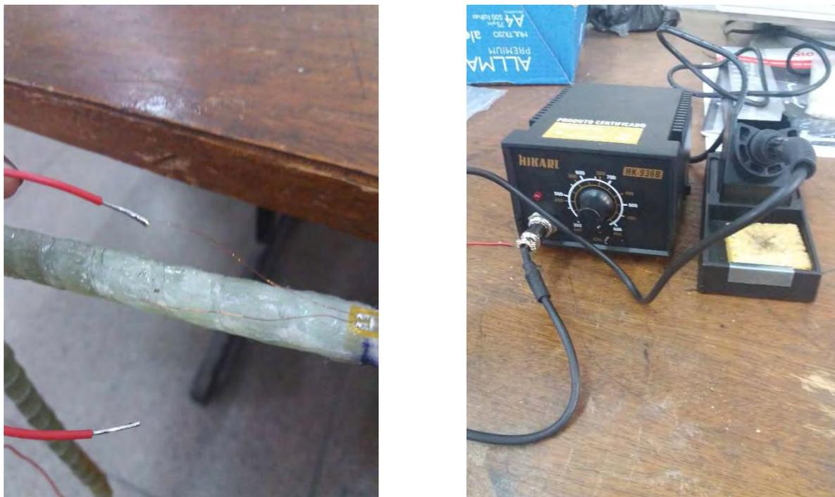
**Figura 53 – Etapa de soldagem dos extensômetros.**
