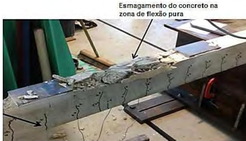
**Figura 25 – Ruptura no concreto.**
