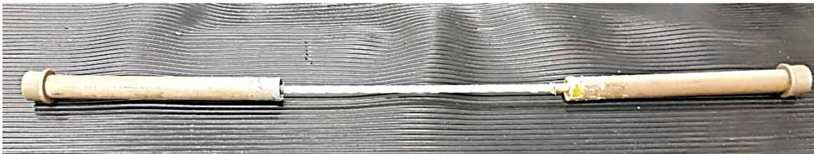
**Figura 40 – Protótipos de barras de GFRP preparados para ensaio tração.**
