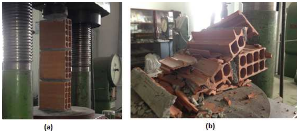
Figura 56 - Ensaio de resistência à compressão nos prismas
