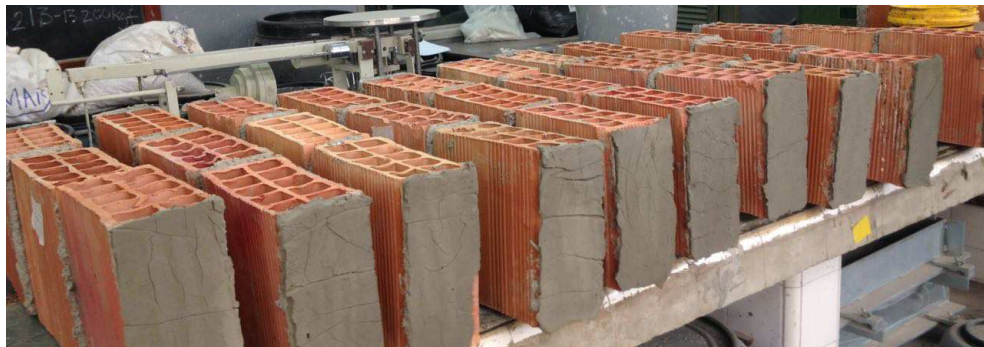
Figura 55 Confeção dos prismas
