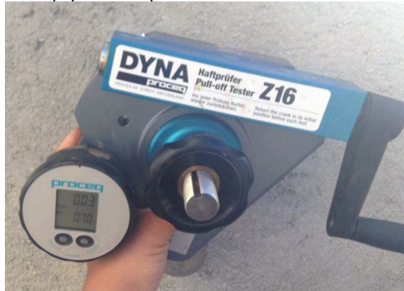
Figura 50 Equipamento para ensaio de arrancamento
