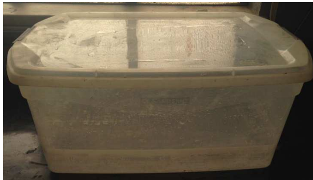
Figura 38 - Recipiente vedado com solução de Cal e água
