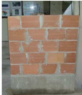
Figura 7 - Alvenaria construída em ambiente controlado para testes
