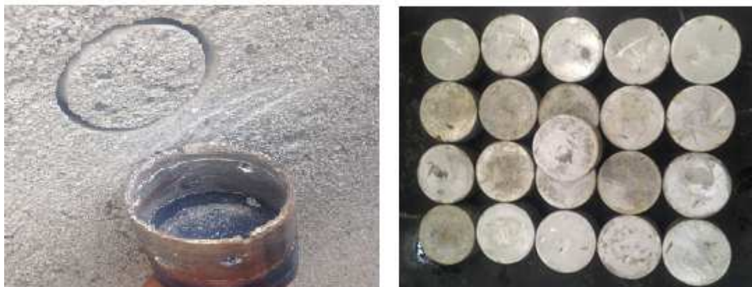
Figura 48 - Furação e pastilhas para ensaio de arrancamento
