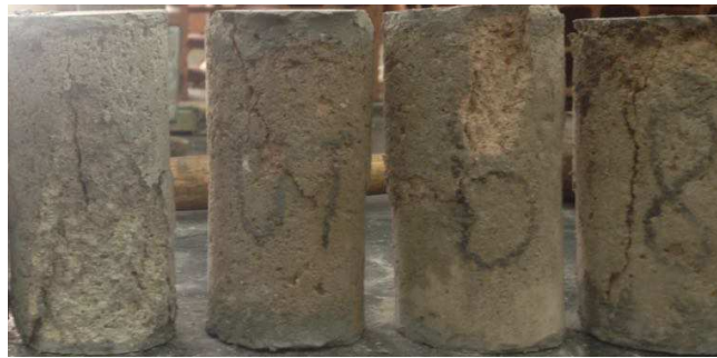
Figura 43 Corpos de prova após ensaio de compressão
