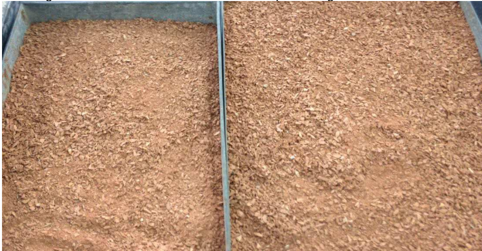
Figura 27 - Resíduo de bloco cerâmico após britagem
