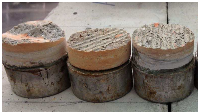
Figura 52 Pastilhas com argamassas aderidas após arrancamento
