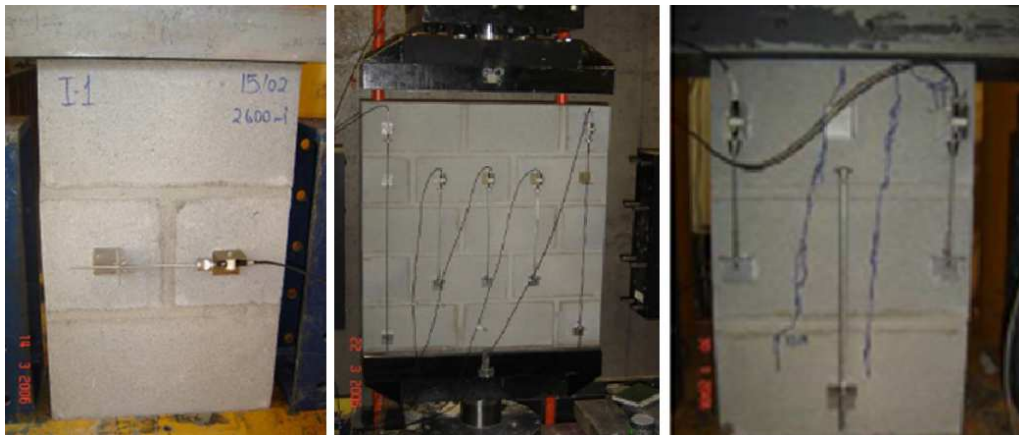
Figura 16 - Ensaio de compressão de prismas e parede
