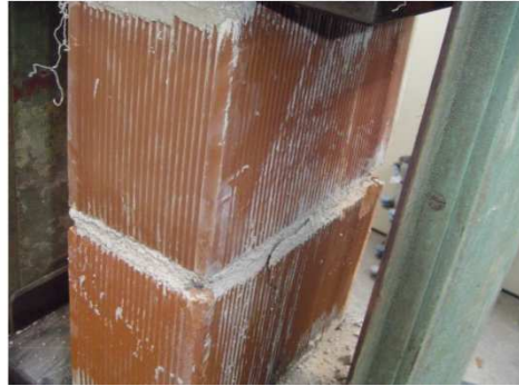
Figura 18 - Ensaio de compressão em prismas de alvenaria
