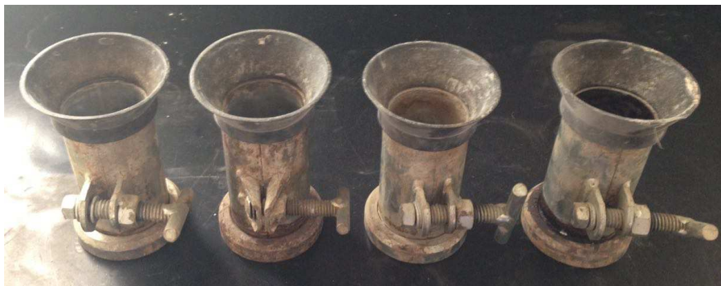
Figura 40 - Moldes para corpos de prova destinados ao ensaio de compressão
