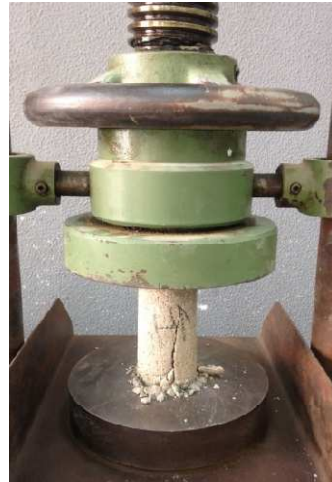
Figura 42 Ensaio de resistência à compressão axial
