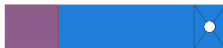
(b) Local onde será aplicada o carregamento na placa de inox com um furo
