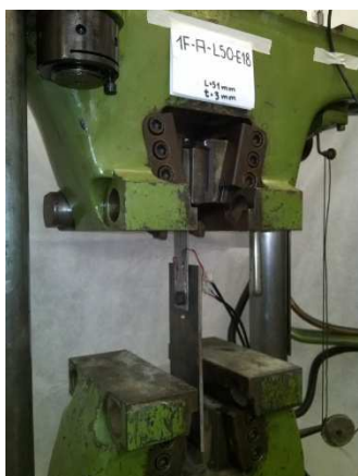
(a) Conjunto do primeiro ensaio montado e fixado ao sistema de aplicação de carga.
