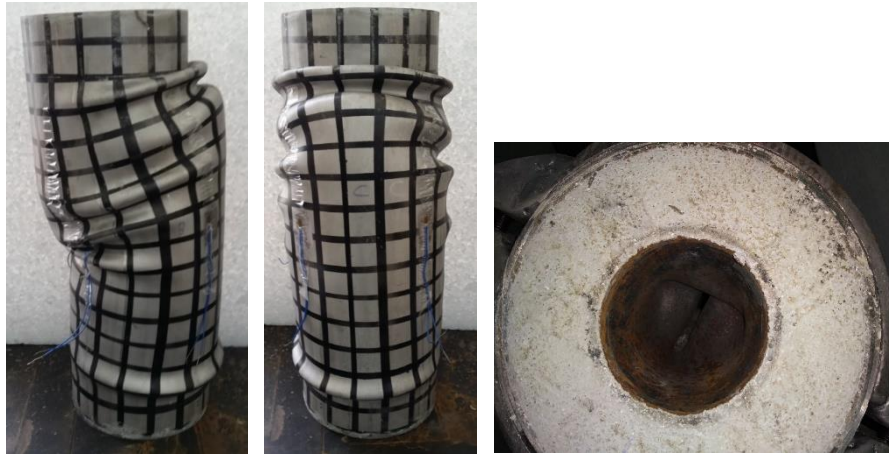
Figura 47 – Modos de falha da coluna C3
