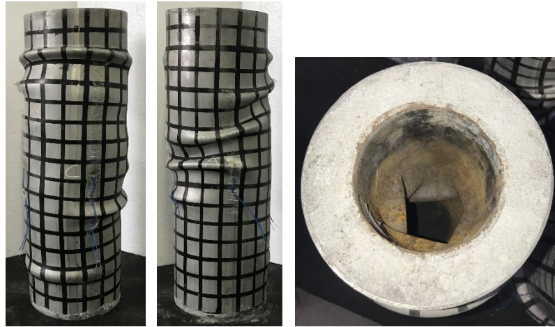
Figura 54 – Modos de falha da coluna C6
