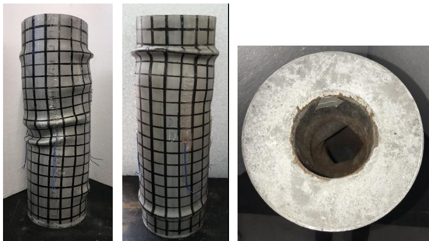
Figura 51 – Modos de falha da coluna C5
