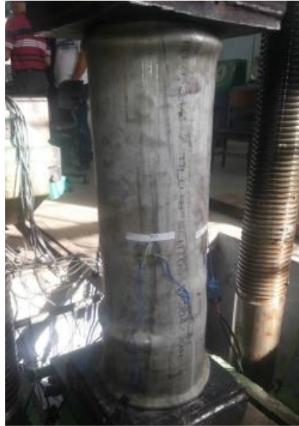
Figura 23 – Modos de flambagem observado na coluna C2-1 [7]
