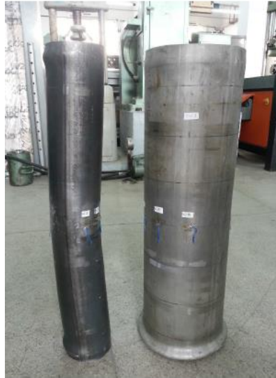
Figura 20 – Modo de flambagem dos tubos da coluna CH2-1 [7]
