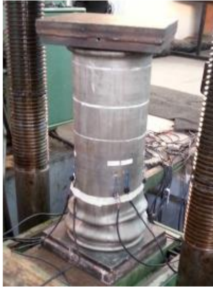
Figura 21 – Modos de falhas da coluna C1-1 [7]
