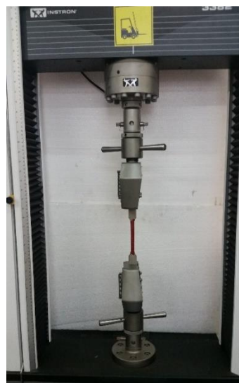
Figura 33 – Ensaio de tração realizado na máquina INSTRON 3382
