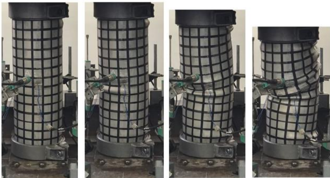
Figura 46 – Evolução deformação coluna C3
