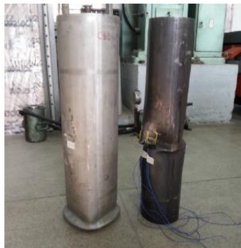
Figura 19 – Modo de flambagem dos tubos da coluna CH1-1 [7]
