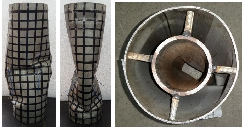
Figura 41 – Modos de falha da coluna CH1
