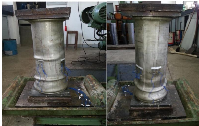
Figura 22 – Modos de falhas da coluna C1-2 [7]
