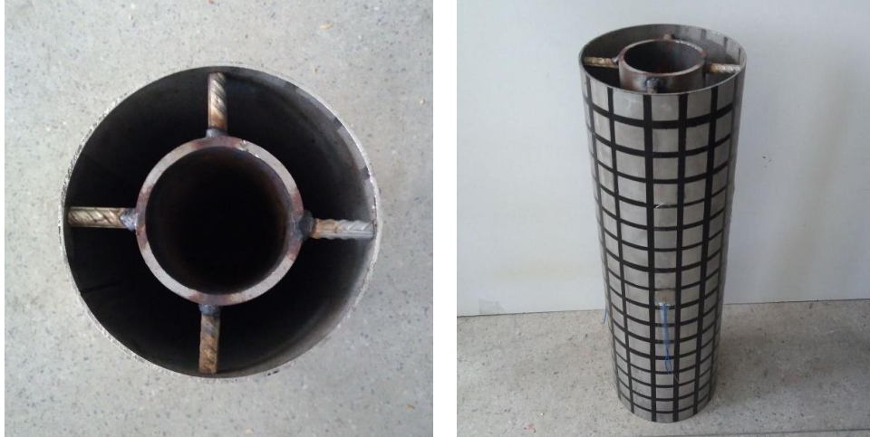
Figura 31 – Posicionamento dos espaçadores entre os tubos
