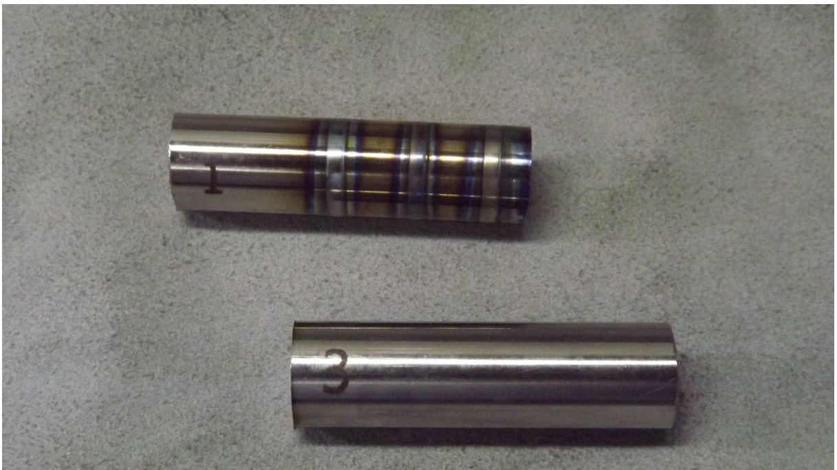
Figura 41 – Corpo de prova antes da soldagem, parte inferior da imagem, e após a soldagem, parte superior da imagem, onde se pode visualizar três cordões de solda.
