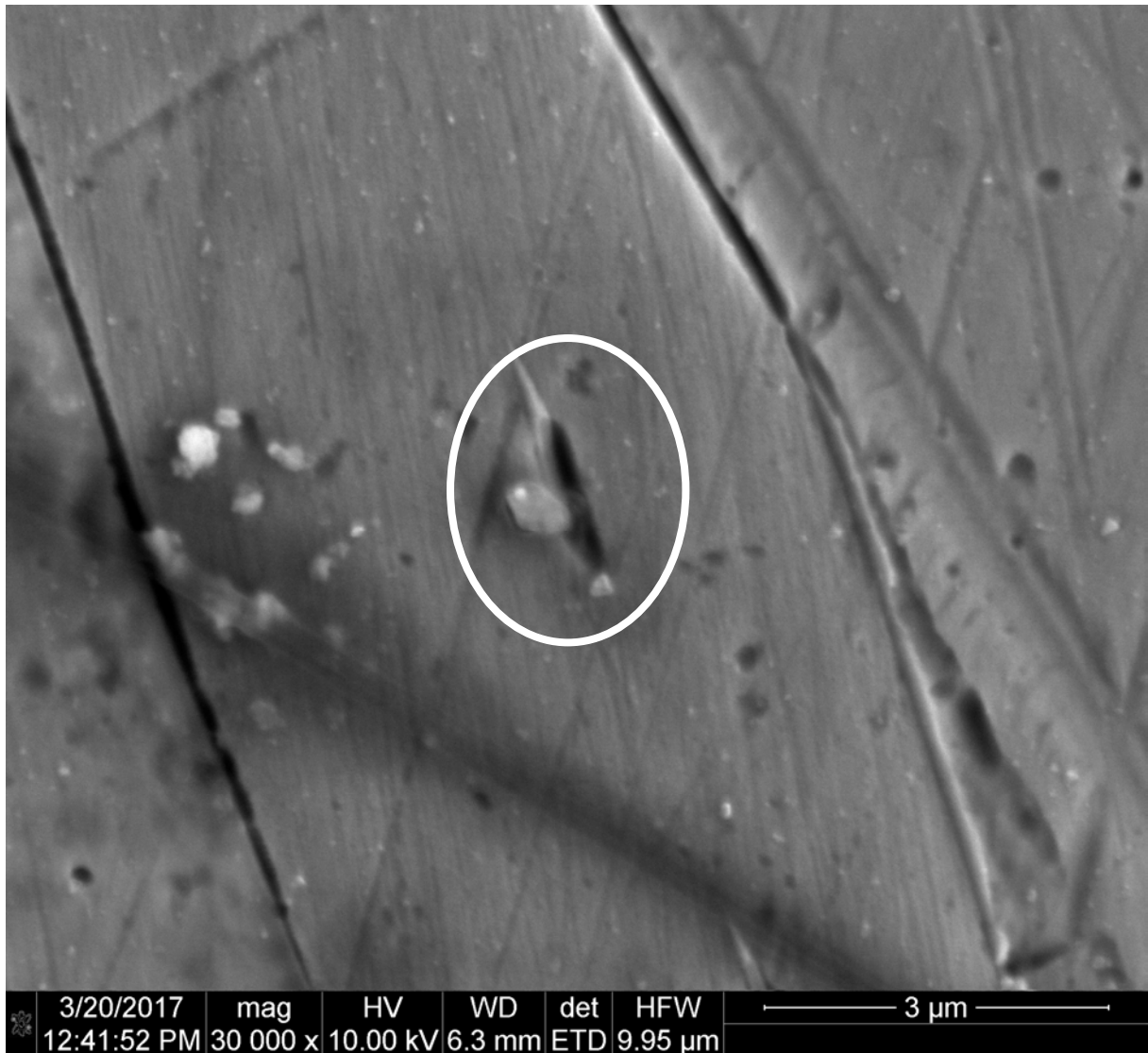
Figura 73 – Micrografias da zona termicamente afetada, amostra com gás de proteção contendo 5,5%N 2 . MEV FEG operando em modo SE, polimento eletrolítico com CrO 3 em ácido acético, 30.000x. Observa-se a presença de região com formato alongado no interior de um grão de austenita.
