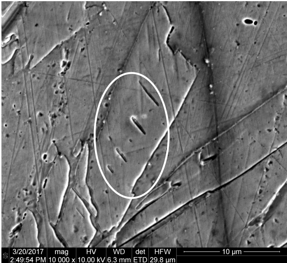
Figura 75 – Micrografias da zona termicamente afetada, amostra com gás de proteção contendo 5,5%N 2 . MEV FEG operando em modo SE, polimento eletrolítico com CrO 3 em ácido acético, 10.000x. Observa-se a presença de regiões com formato alongado no interior de um grão de austenita.
