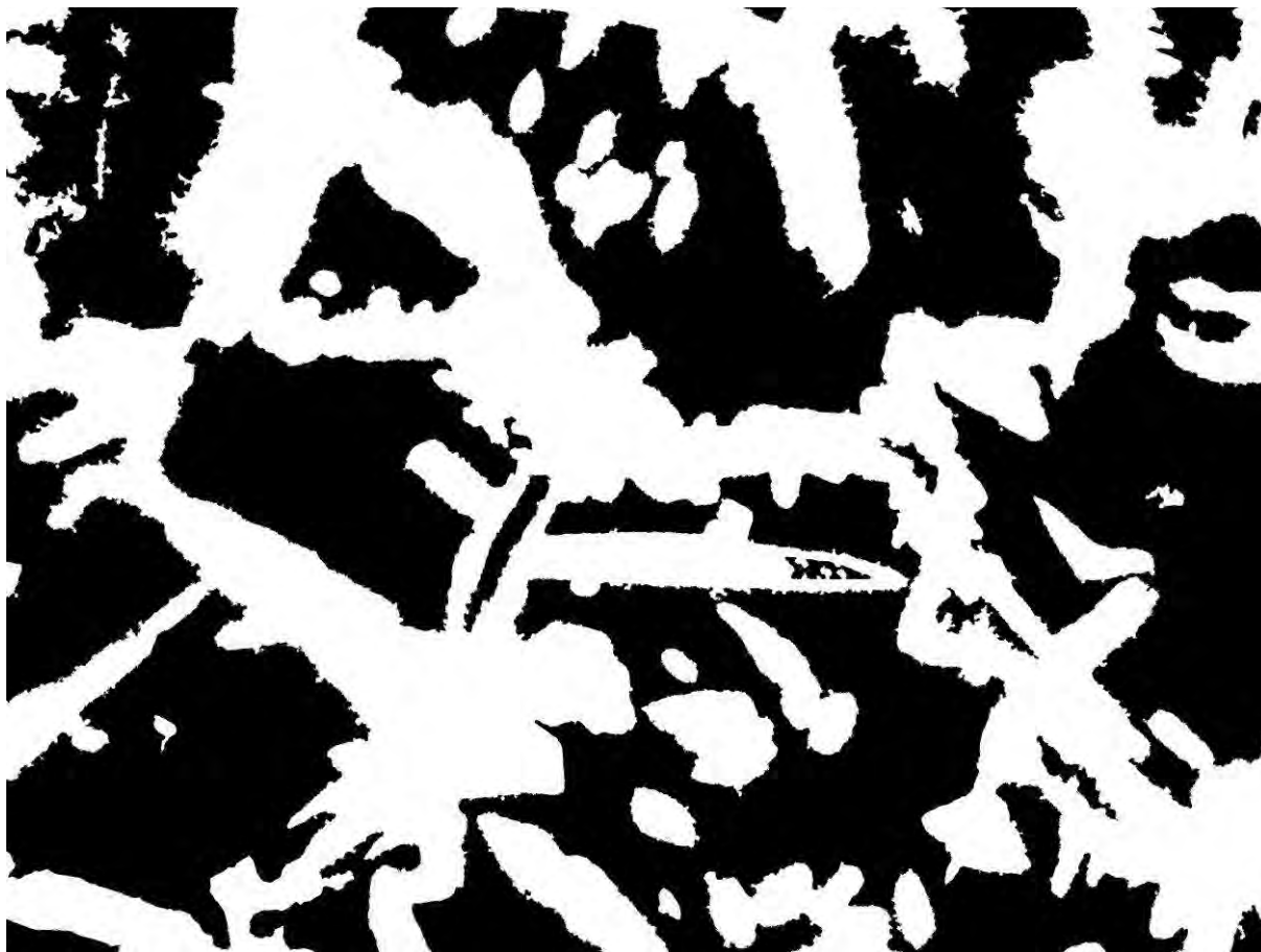
Figura 88 – Imagem apresentada na Figura 87, após eliminação de objetos e furos de pequenas dimensões, problemas gerados na etapa de segmentação. A fase ferrita possui coloração preta e a austenita branca.
