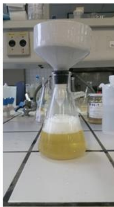
Figura 19 – Filtração da lignocelulose ácida para a retirada do hidrolisado
