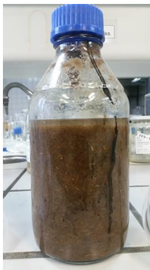
Figura 17 – Solução composta de material lignocelulósico e H 2 SO 4 diluído
