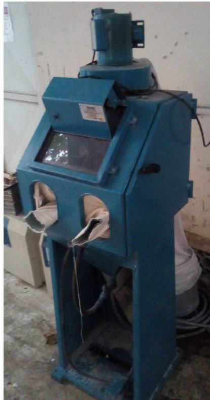
Figura 16 – Cabine de jateamento abrasivo utilizada no preparo superficial das amostras e ferramentas.
