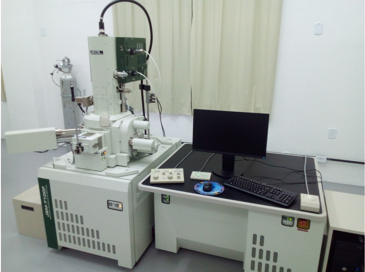
Figura 20 – Microscópio eletrônico de varredura de emissão de campo (MEV-FEG) pertencente ao NanoFab/UERJ.
