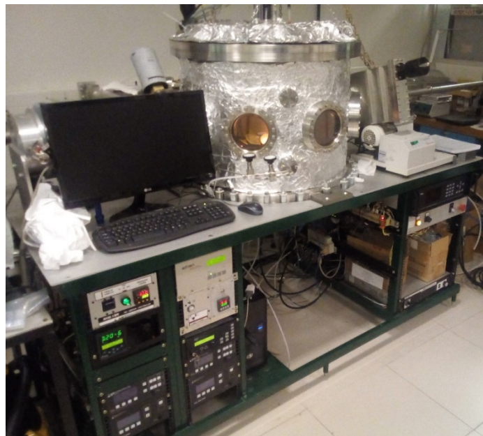
Figura 22 – Reator magnetron sputtering instalado no Laboratório de Superfícies e Nanoestruturas/CBPF, utilizado para a realização do processo de nitretação a plasma e deposição do filme de TiN.
