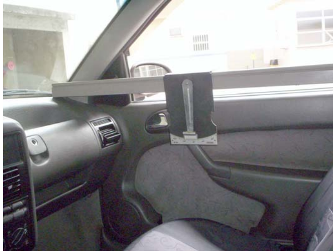
Figura 22 - Dispositivo adaptado para medição de inclinações
