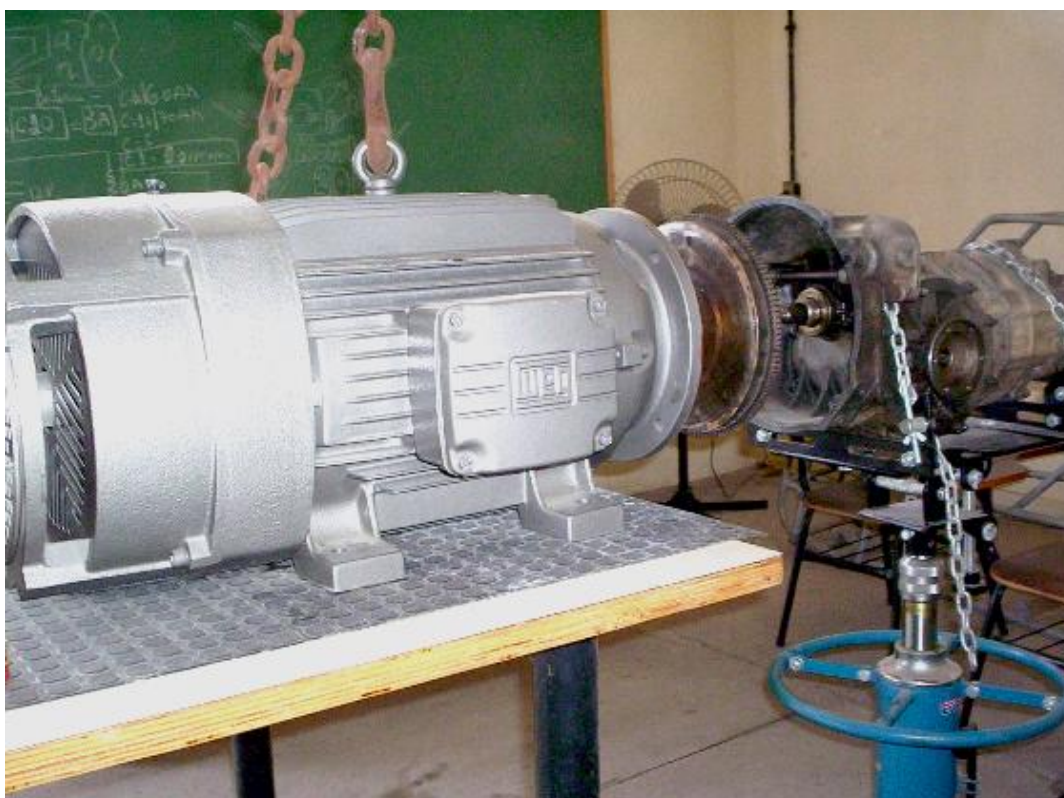
Figura 47 - Acoplamento projetado para adaptação do motor elétrico na caixa de marchas
