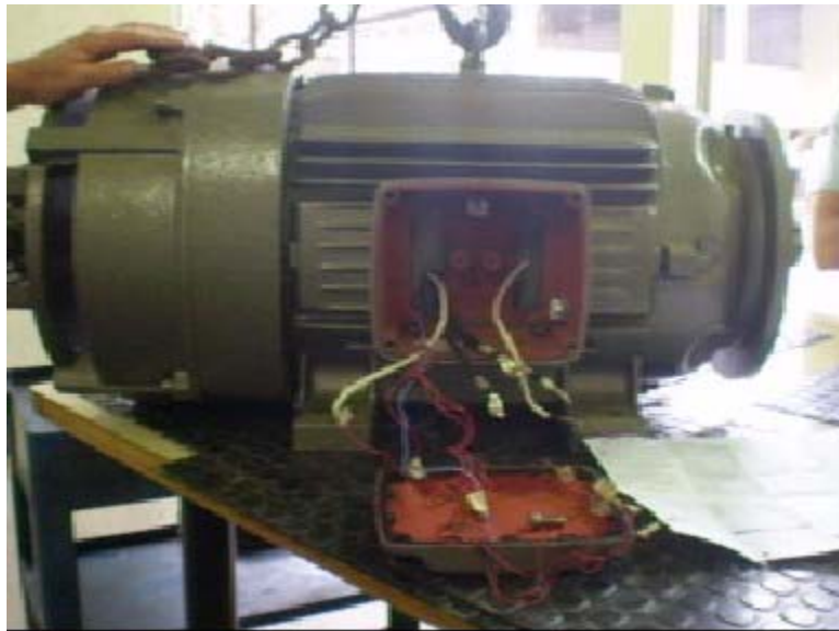
Figura 25 - Motor de ímã permanente (especial) Alto Rendimento Plus da WEG
