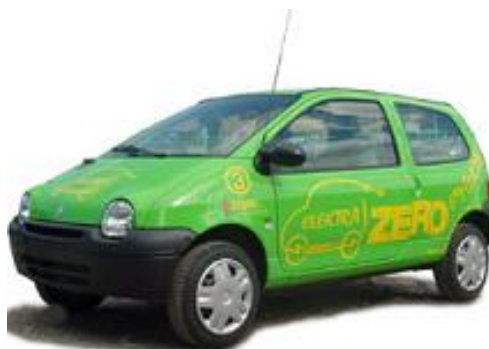
Figura 11 - Veículo Twingo, eletrificado pela MES-DEA
