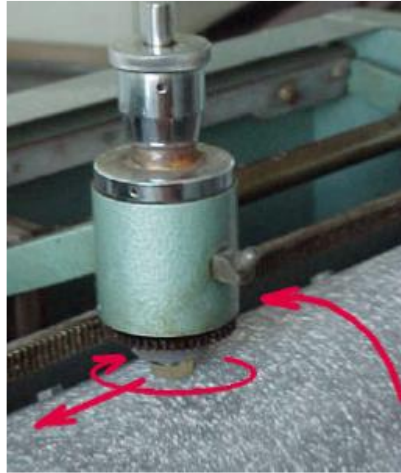
Figura 9 – Esquema dos movimentos sofridos por corpo de prova contra a superfície abrasiva (lixa 1200) na máquina de ensaio de abrasão.
