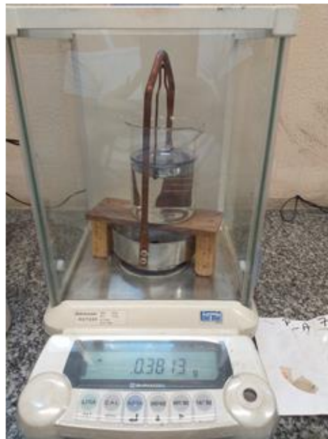
Figura 10 – Ensaio para determinar a densidade do experimento pelo método hidrostático segundo a norma ASTM D297.
