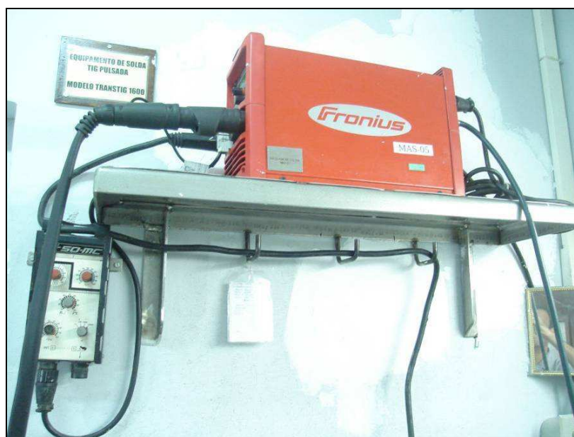
Figura 13 – Máquina solda Fronius (modelo Transtig 1600) utilizada para a soldagem dos corpos de prova.
