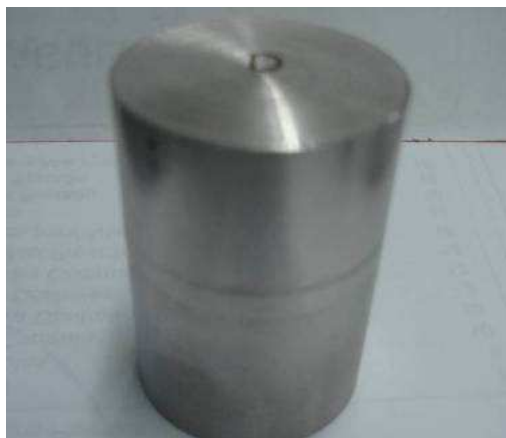
Figura 42 – Aspecto obtido da junta soldada.
