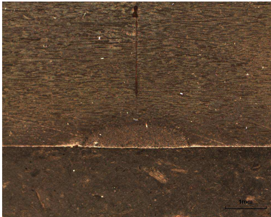
Figura 25 – Macro da junta soldada do Grupo 3 – Aumento 20x – Ataque químico: Behara.
