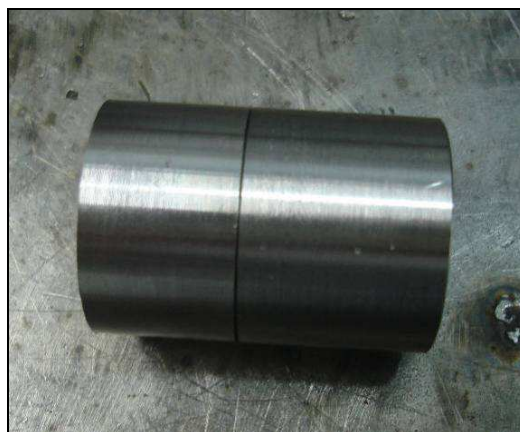
Figura 10 – Montagem das peças para a solda.
