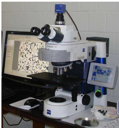
Figura 22 – Microscópio óptico modelo Axiomager M1m da marca Zeiss, laboratório de microscopia óptica e caracterização de materiais - LabMat - do Laboratório de Engenharia Mecânica da UERJ.
