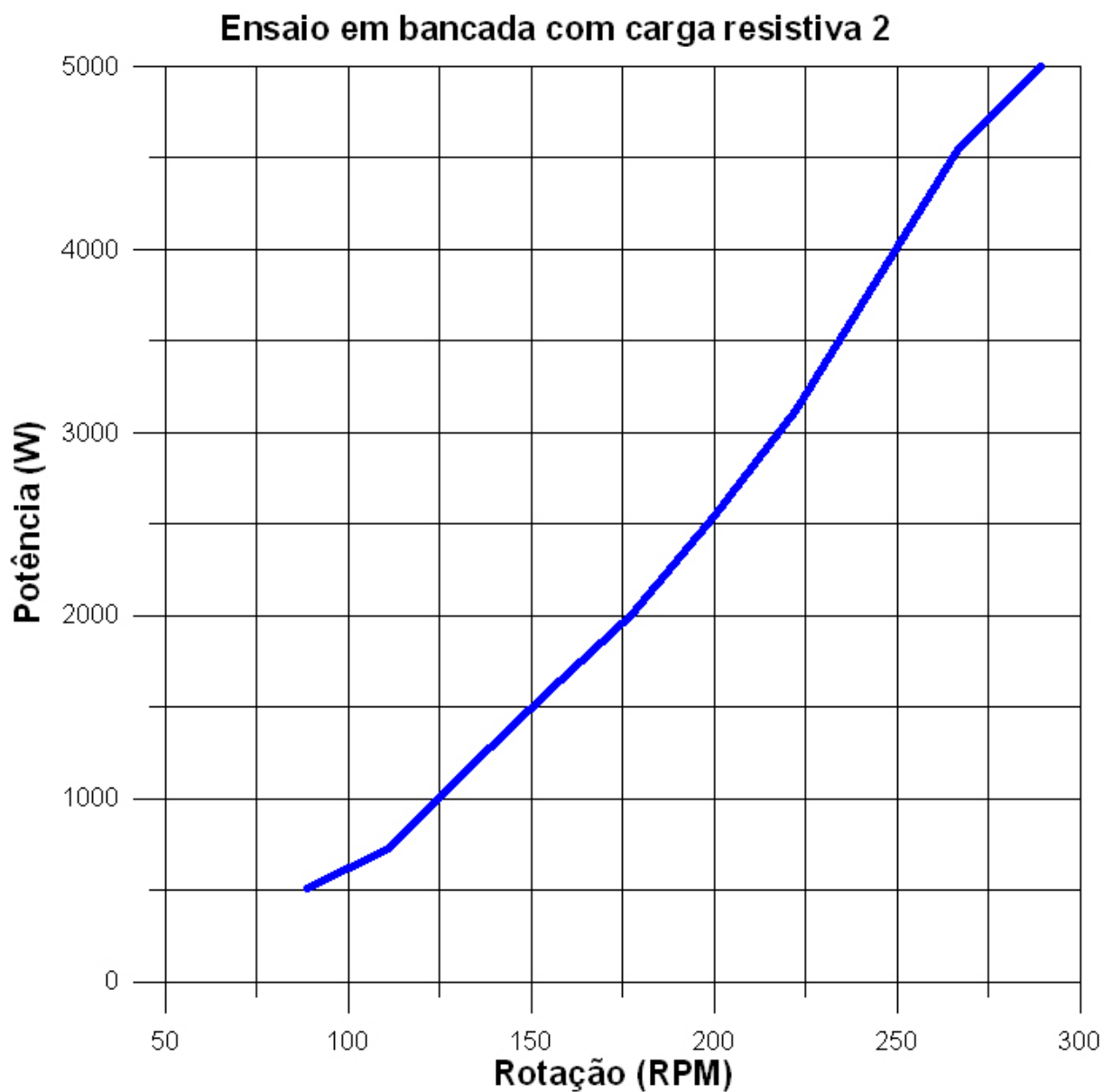
Figura 92: Gráfico Potência x RPM do ensaio em bancada com carga resistiva 2. (gráfico elaborado pelo autor utilizando o software Grapher 6.0)
