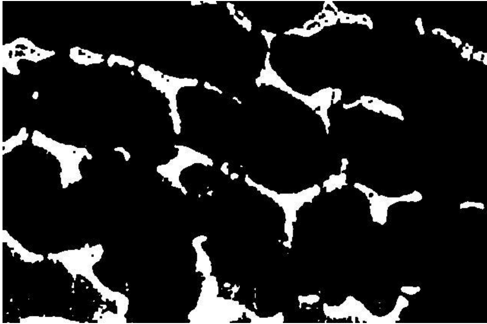
Figura 73 – Imagem da Figura 72 após comando Close .
