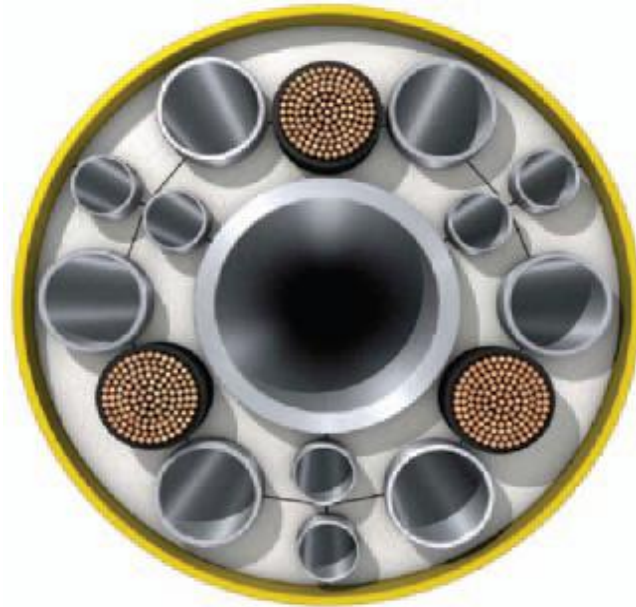
Figura 08. Representação esquemática da seção transversal do “ subsea umbilical ” [Chai, et. al., 2009].
