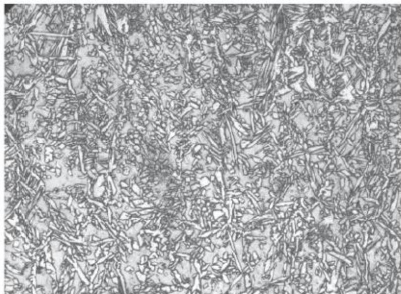
Figura 22. Microestrutura da junta soldada obtida pelo método TIG de uma amostra tubo com 168mm de diâmetro e 7,1mm de espessura. 150x [Stenvall e Holmquist, 2008].
