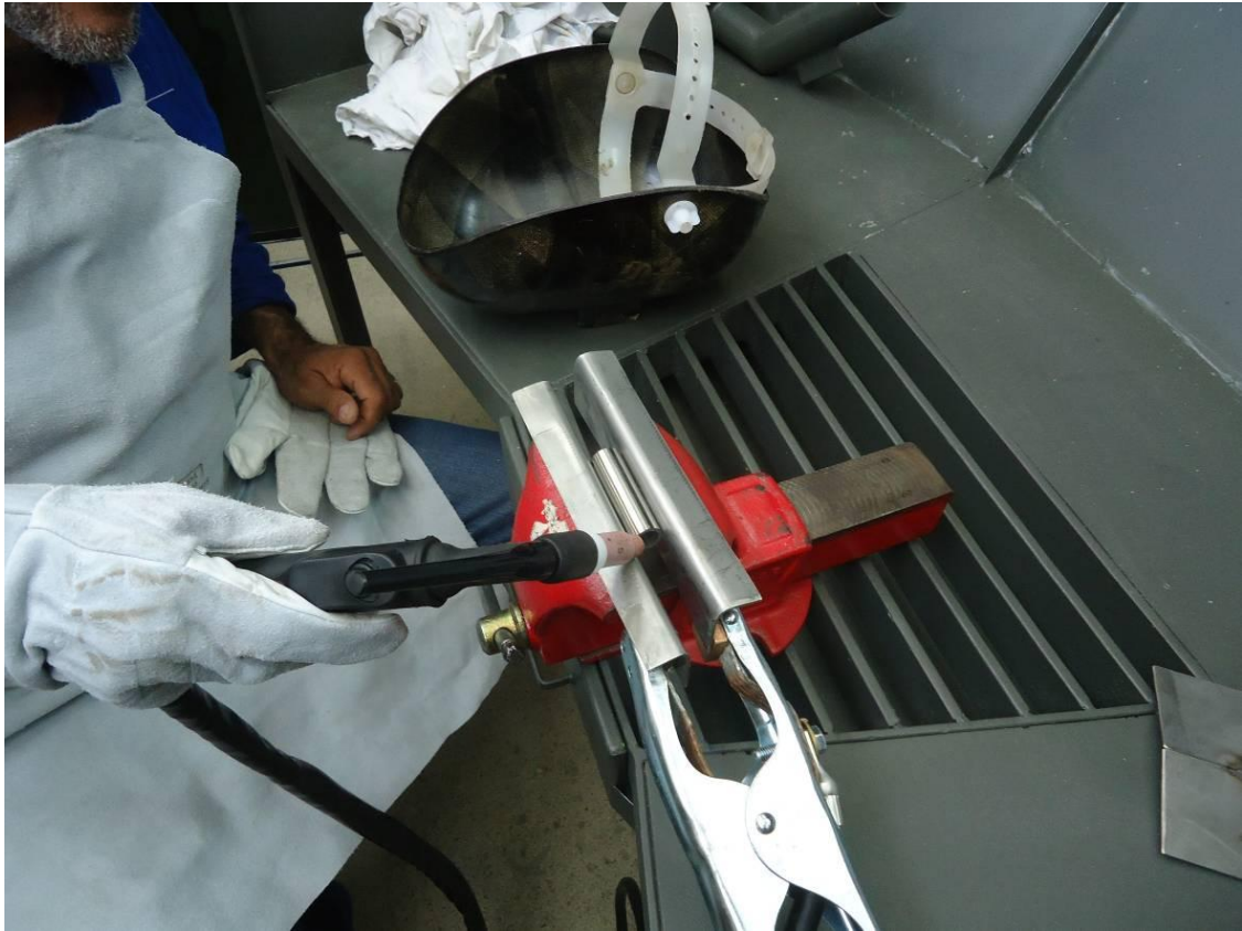
Figura 63 – Amostra fixada no torno de bancada pronta para soldagem.
