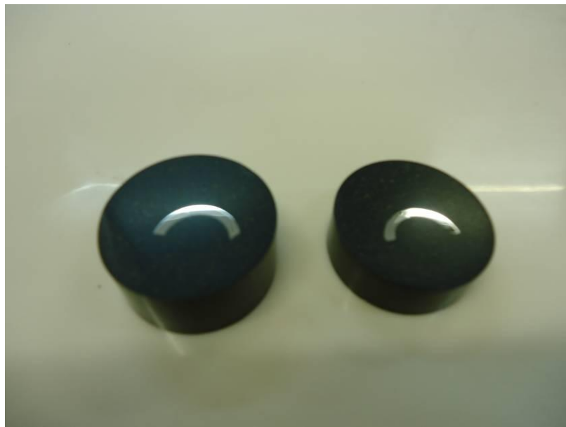
Figura 64 – Amostras após as etapas de embutimento, lixamento e polimento.
