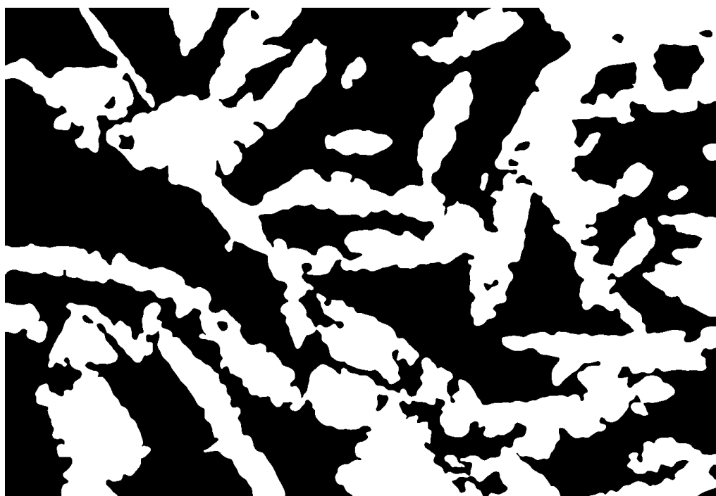
Figura 108 - Imagem da microestrutura após aplicação do comando de preenchimento de furos sobre a imagem da Figura 107.
