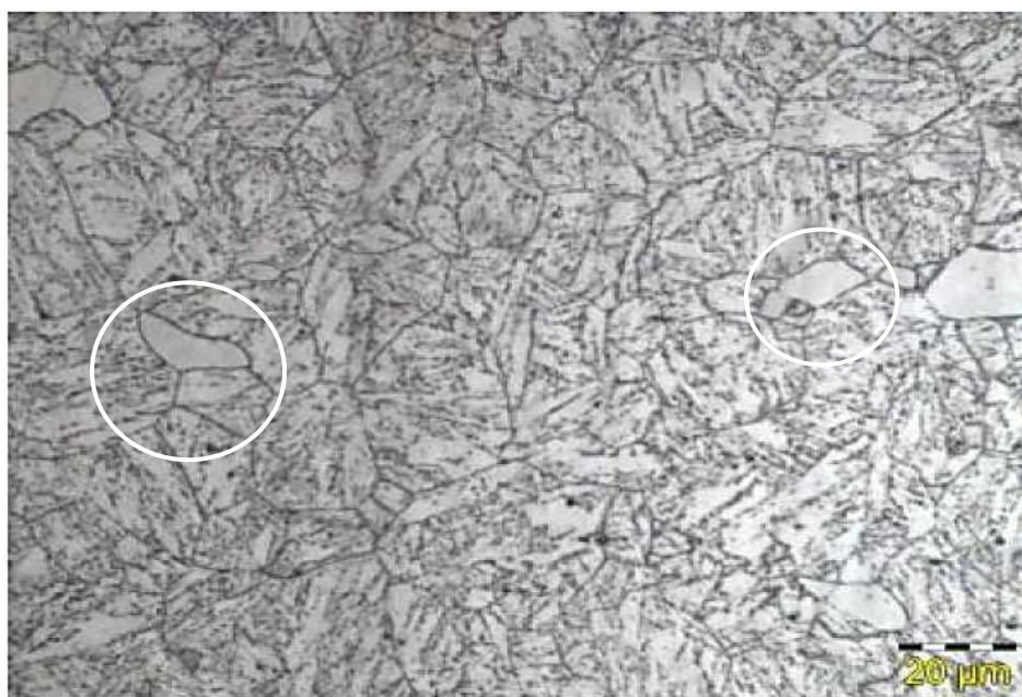
Figura 10. Imagem da microestrutura martensita revenida com presença de ferrita \delta no aço P92, obtida por microscopia óptica após ataque químico com reagente Vilella, aumento de 1000x [Adaptado de Ferreira, 2010].
