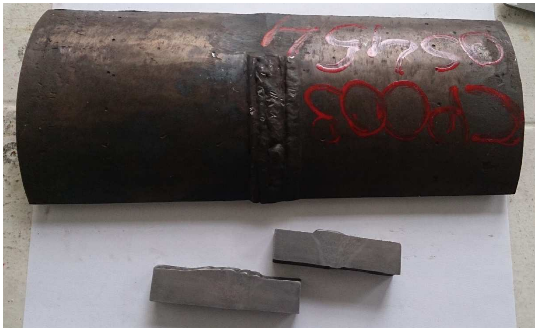
Figura 5. Amostras para análise macro e micrográfica.
