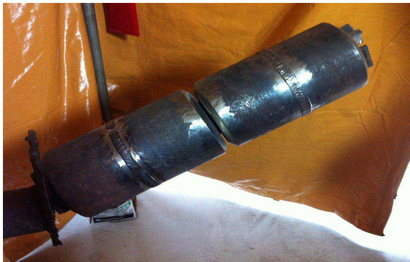
Figura 2. Tubo na posição 6G para soldagem.
