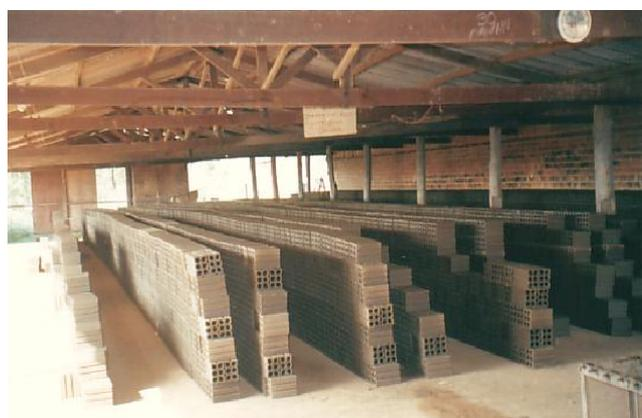
Figura 2: Secagem de tijolos crus em galpão aberto.
