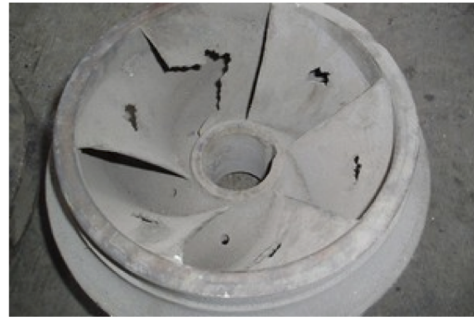
(b) Rotor de uma bomba centrífuga danificado pela cavitação
