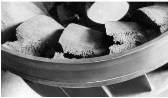
(a) Rotor de uma turbina danificado por cavitação
