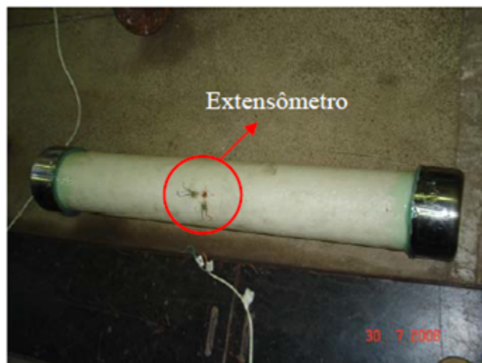
Figura 38 - Fotografia da montagem do ensaio realizado com tubo compósito. Fonte [2]
