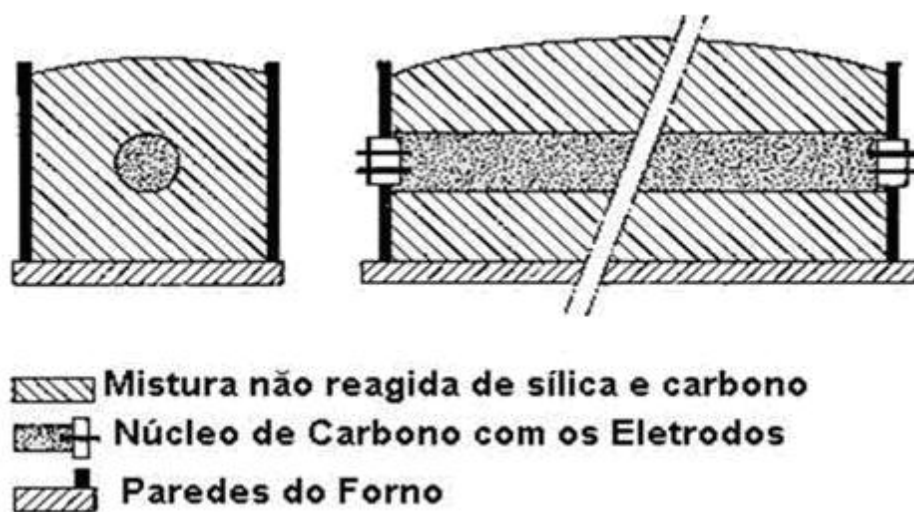
Figura 06: Representação esquemática do forno para síntese do carbeto de silício (antes da redução carbotérmica), adaptada de Beltrão M. S. S. [2].
