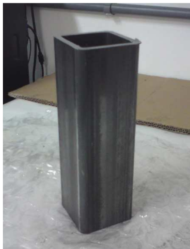
Figura 19 – Amostra do tubo utilizada nos ensaios de tensão residual.
