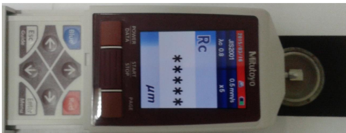
Figura 2.7 – Rugosímetro digital posicionado para ensaio.
