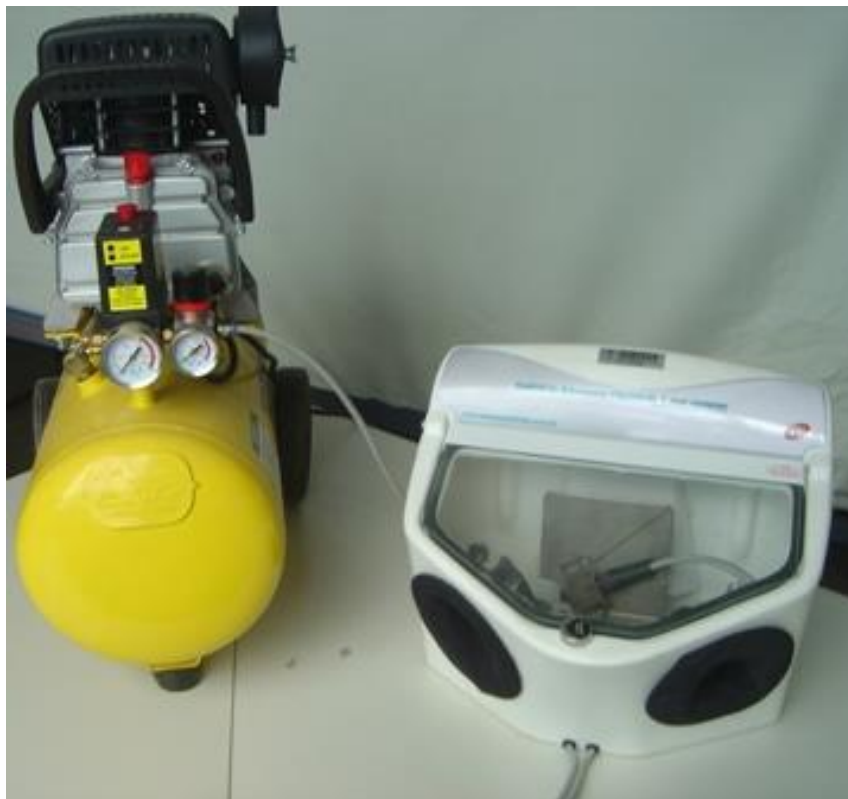
Figura 2.4 – Instalação para produção do ataque erosivo: câmara de jateamento e compressor.
