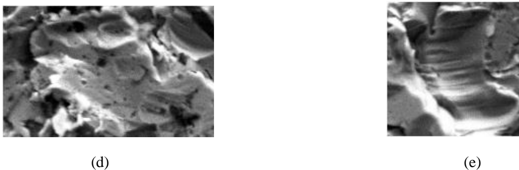
Figura 3.2 - Detalhes da amostra 1 com aumento de 1000X: (d) região exemplificando a quantidade de cavidades; (e) formação de placas regularmente espaçadas.
