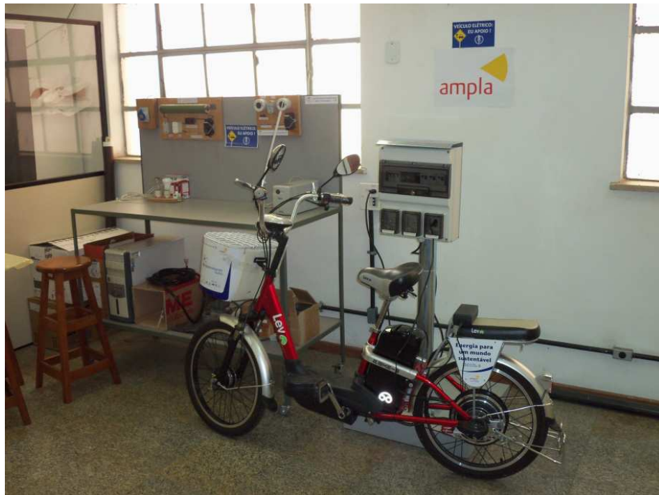
Figura 2.17 – Bicicleta elétrica LEV durante ensaio de recarga
