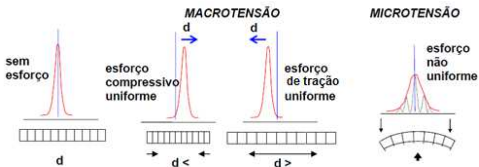
Figura 6 – Efeito de esforços uniformes e não uniformes sobre a estrutura cristalina [14].
