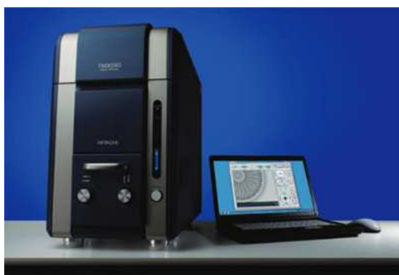
Figura 39 – MEV de bancada HITACHI modelo TM3000 [36].
