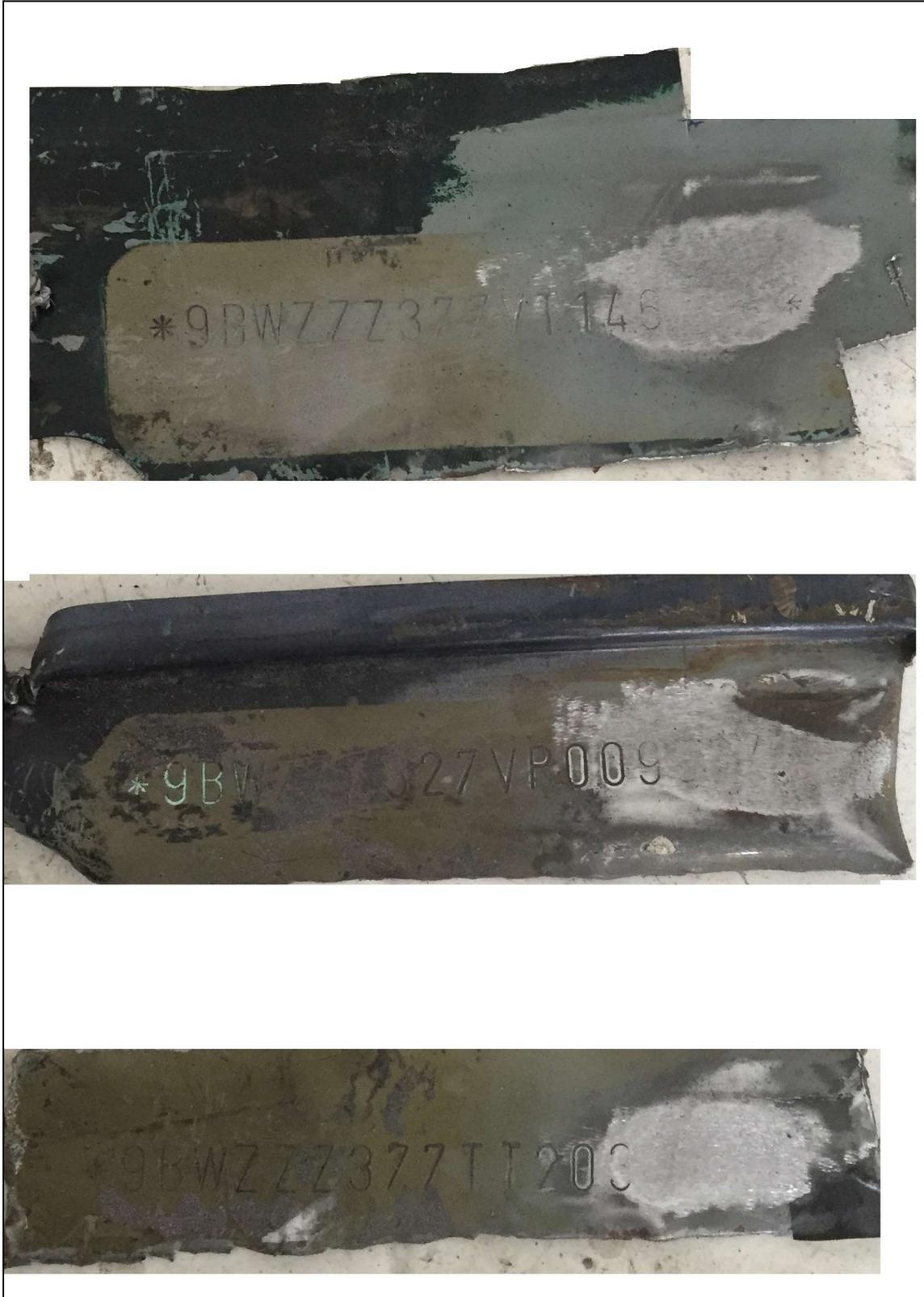
Figura 39 - Amostras do grupo B com gravação NIV suprimida por desbaste
