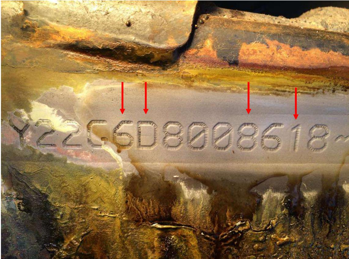
Figura 17 - Vestígios de adulteração revelados pelo método de ataque químico, utilizando o reagente Bessmann-Haemers (Foto: Erick B Lima).
