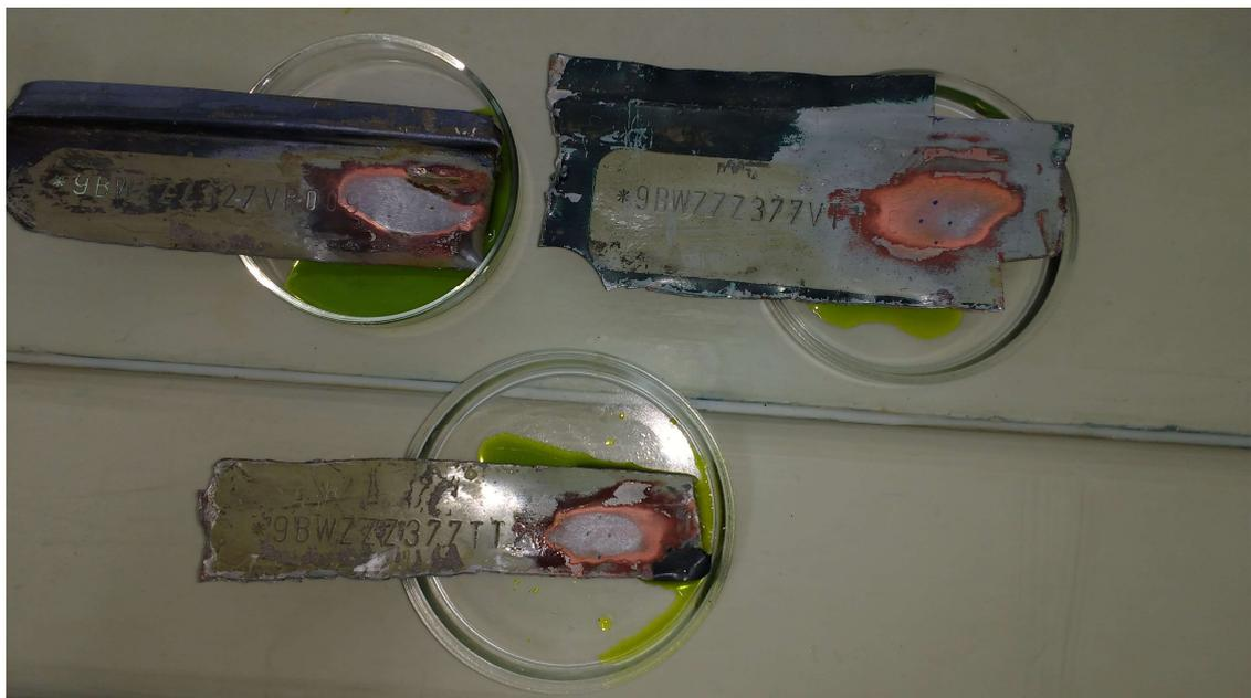
Figura 40 – Técnica de aplicação do reagente Fry sobre as amostras.
