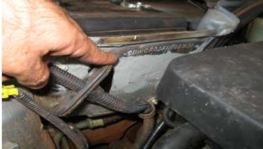
Figura 13 - Mudança de posição. A gravação original foi eliminada e uma nova gravação (inidônea) foi realizada (MIZIARA e BARROS, 2008).
