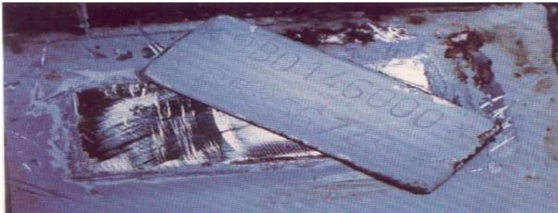
Figura 11 - Implante ou Enxerto. A gravação original do NIV encontrava-se oculta pela sobreposição de chapa metálica com outra gravação NIV (MIZIARA e BARROS, 2008).
