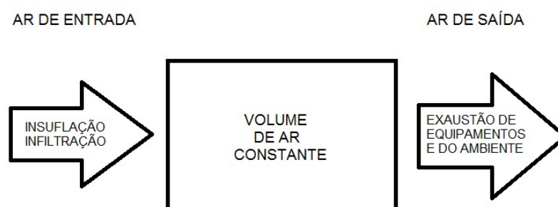
Figura 3.8 – Fluxo de ar em laboratórios de volume constante.
