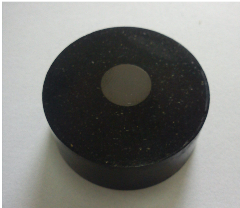
Figura 24: Amostra de carbeto de boro embutida em baquelite
