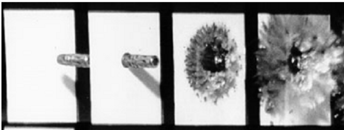
Figura 3: Projétil atingindo uma placa cerâmica. Fonte: COSENTINO, 2006, p. 16.
