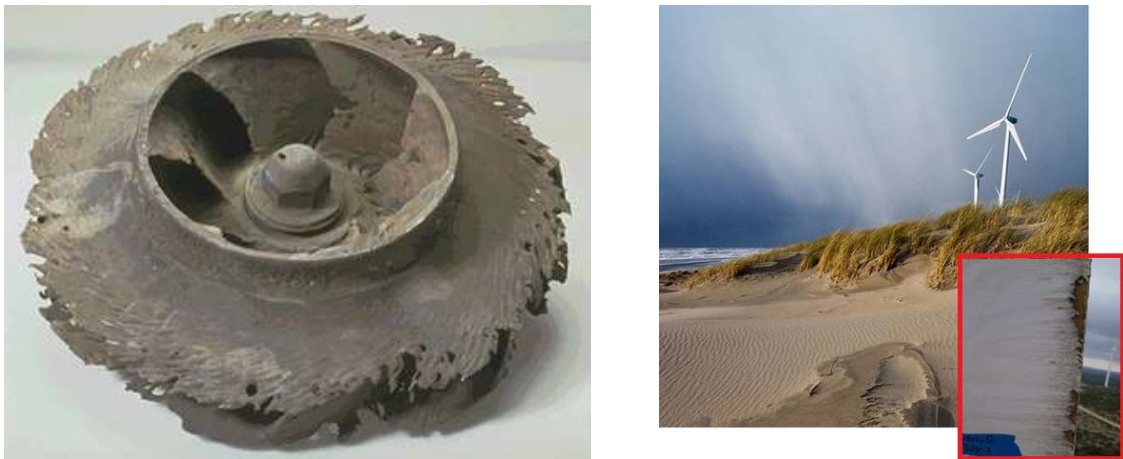
Figura 1 – Desgaste por erosão por impacto de partículas.
