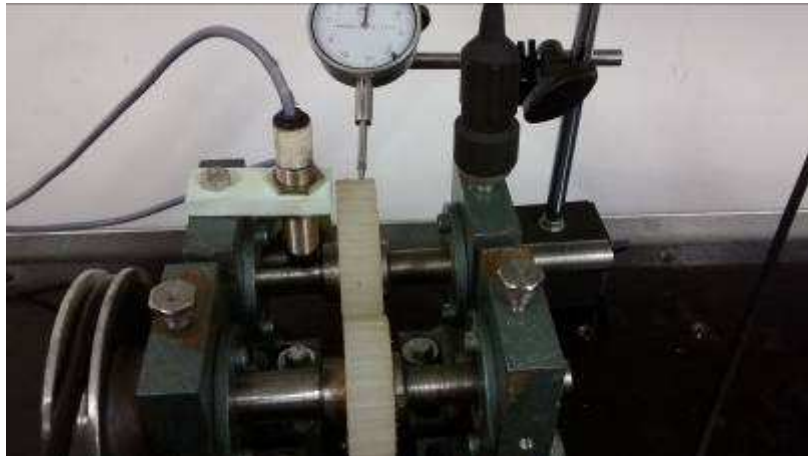
Figura 56 - Medição de folga entre as engrenagens 1 e 2.
