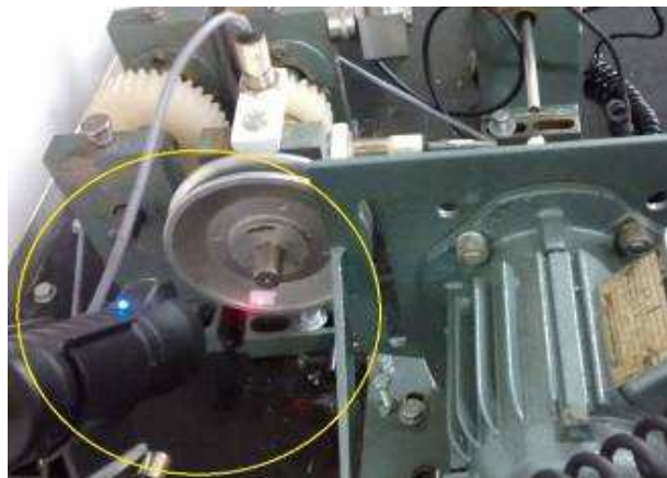
Figura 47 - Medição de velocidade do eixo dos ensaios R1 e R2 com Tacômetro.
