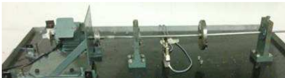
Figura 25 - Configuração um disco centralizado no vão de 590 mm entre mancais.
