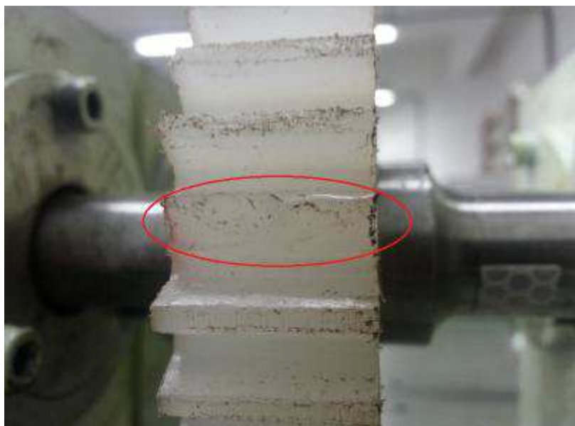
Figura 57 - Dente com defeito da engrenagem 2.
