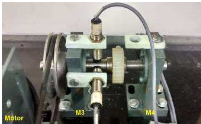
Figura 45 - Configuração da bancada experimental para os ensaios R1 e R2.
