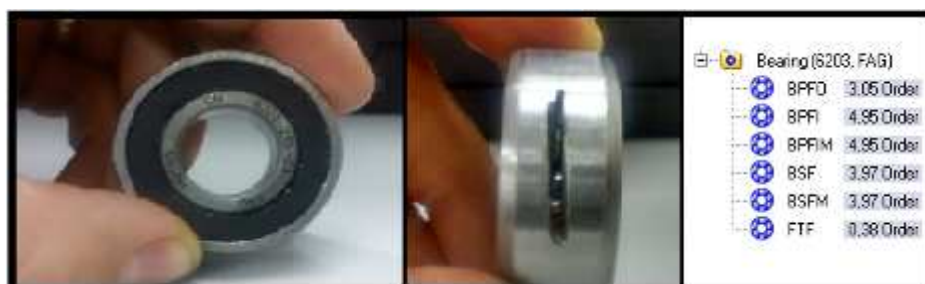
Figura 46 - Rolamento FAG 6203 com o defeito gerado e suas freq. de defeitos.
