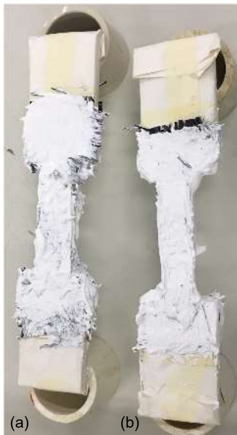
Figura 18: Corpos de prova de tração com revestimento. a) corpos de prova de acordo com o primeiro esquema de revestimento. b) corpos de prova de acordo com o segundo esquema de revestimento.
