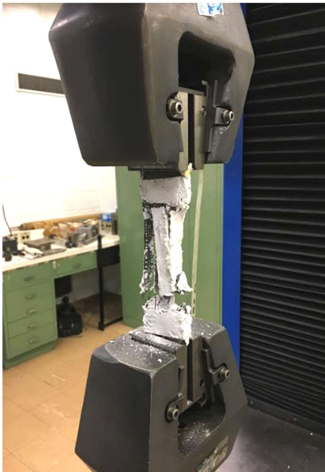
Figura 32: Teste de tração em sistema substrato aço / revestimento. Houve um “descolamento” dos revestimentos das superfícies do substrato.
