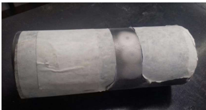
Figura 31: Aspectos obtidos para os pontos jateados em tubulação revestida com carboneto de tungstênio. Amostra cedida pelo CEPTEL.
