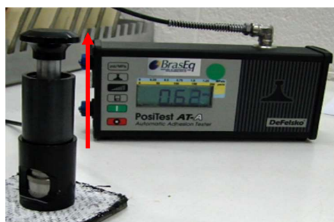
Figura 13: Ensaio de aderência. Equipamento Positest AT-A: Automatic Adhesion tester da Defelsko.
