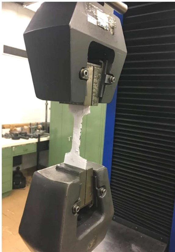
Figura 33: Ensaio de tração feito apenas no revestimento.
