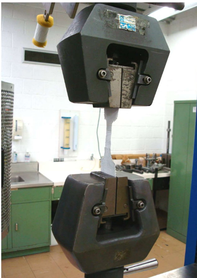
Figura 20: Ensaio de tração do Corpo de prova do material do revestimento.
