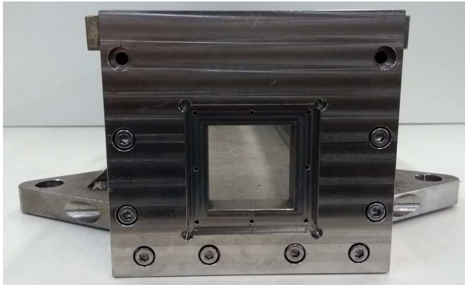
Figura 33 – Janela quadrada traseira para passagem de radiação onde é acoplado o detector de raios X.
