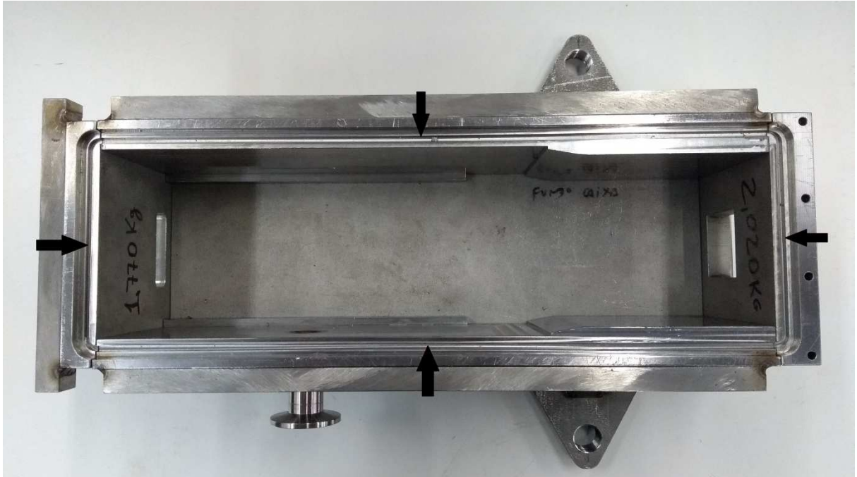
Figura 37 – Câmara de Raios X para colocação da amostra em ambiente evacuado. As setas indicam o rebaixo usinado para o encaixe do O'Ring de Borracha.
