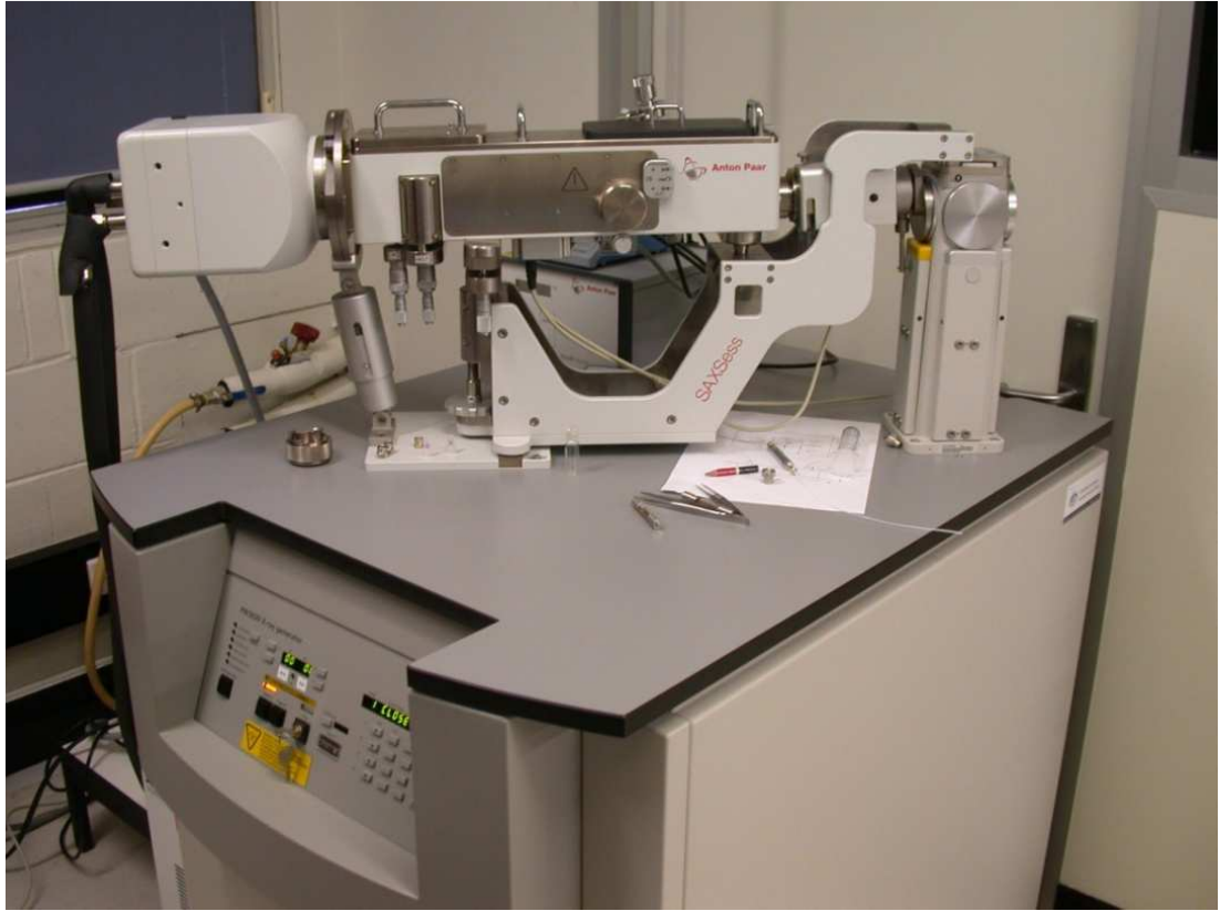
Figura 31 - Equipamento de SAXS da fabricante Anton Paar, atualmente comercializado com o sistema de colimação em bloco.
