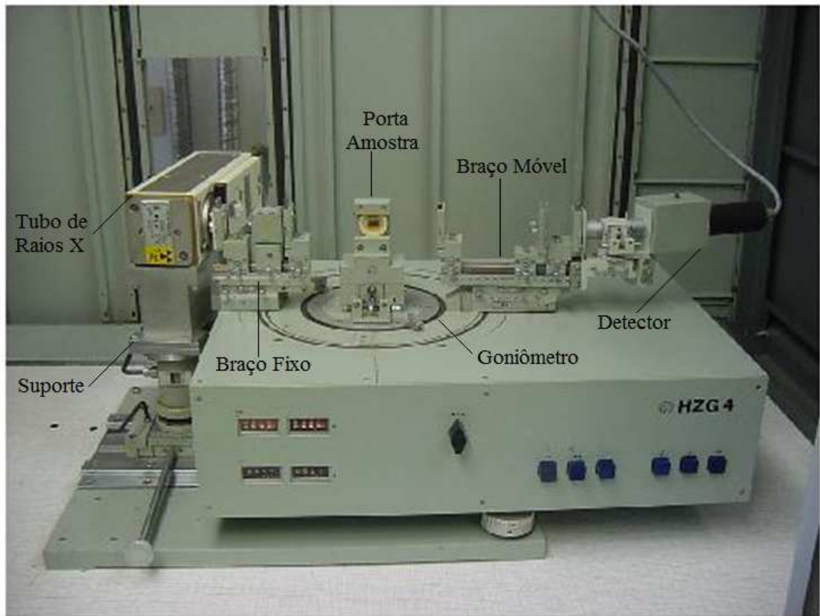
Figura 29 - Equipamento de difração de raios X Seifert HZG 4, base para o desenvolvimento da instrumentação da óptica para SAXS.
