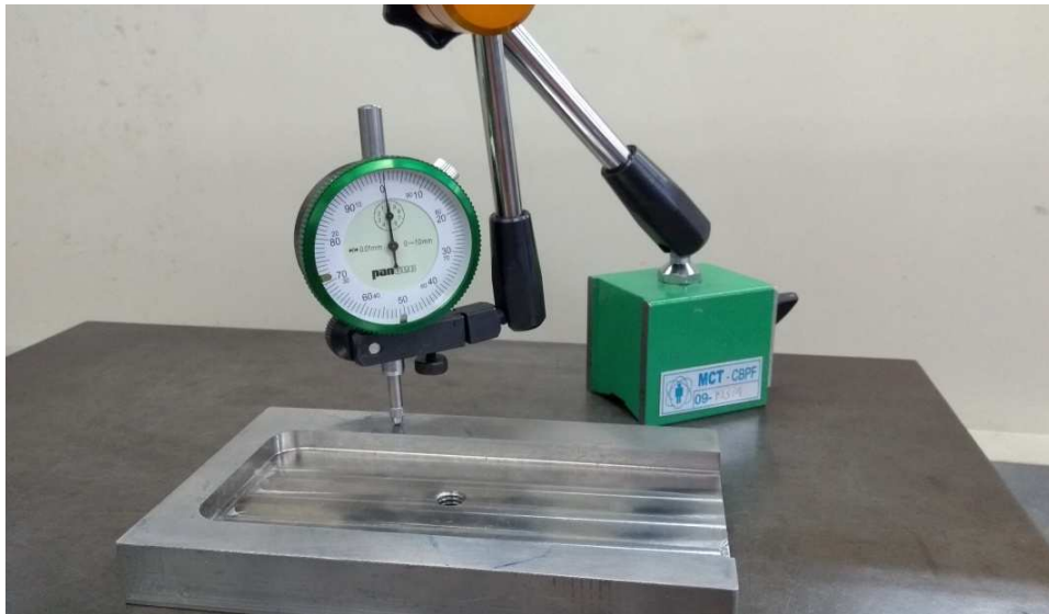
Figura 44 – Verificação da Variação da Geometria do Bloco de Colimação com um relógio comparador.
