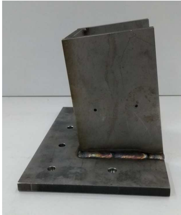
Figura 40 – Suporte do Tubo de Raios X Soldado na Base pelo Processo TIG.
