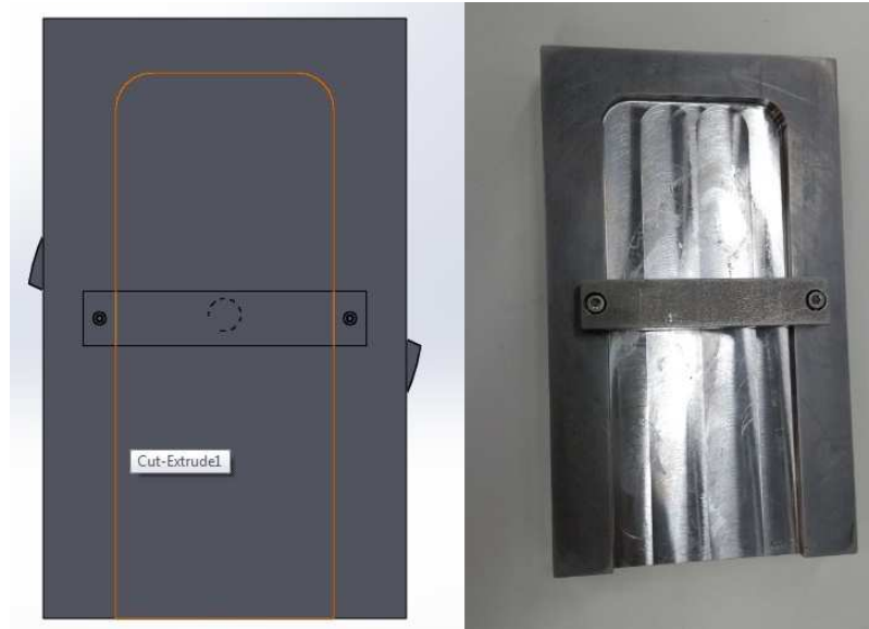
Figura 50 – Bloco de Colimação Projetado e a Peça. (O autor)
