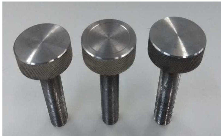
Figura 39 – Parafusos de Ajustes de Alinhamento do Feixe de Raios X e para Inclinação da Câmara.
