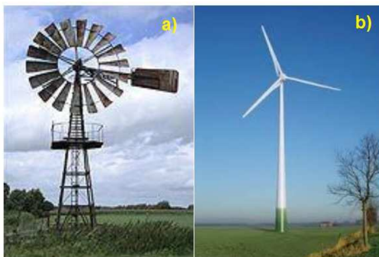
Figura 6 - Turbinas de eixo horizontal. a) Rotor de múltiplas pás; b) Rotor com três pás [13].
