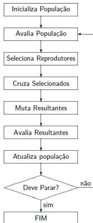
Figura 33 - Fluxograma de um algoritmo genético (adaptado) [35].
