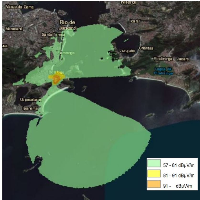
Figura 34 - Mapa de Cobertura de Botafogo, Transmissor da SFN2, com o modelo ITU-T P.1546.
