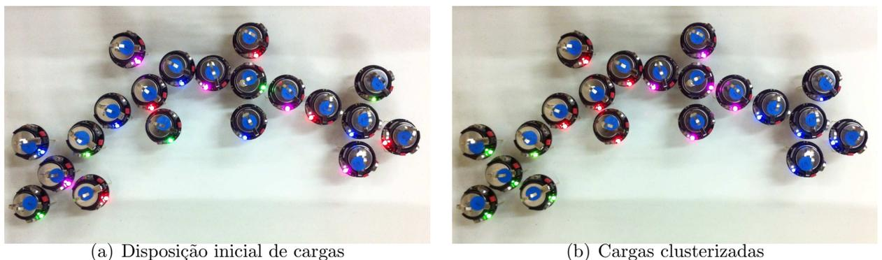
Figura 30: Enxame de 20 *Kilobots*, 4 classes e 15 cargas estáticas iniciais
