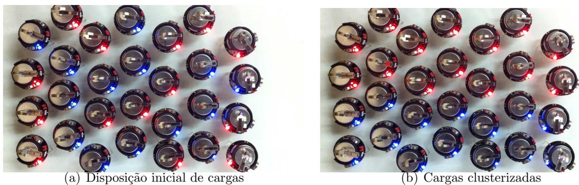
Figura 20: Enxame de 28 *Kilobots*, 2 classes e 14 cargas estáticas iniciais
