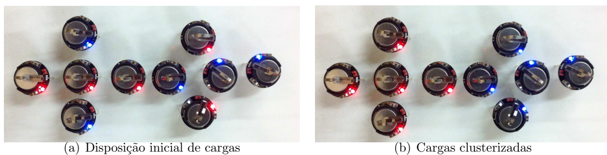
Figura 40: Experiência 2: enxame de 10 Kilobots , 2 classes e 5 cargas estáticas iniciais
