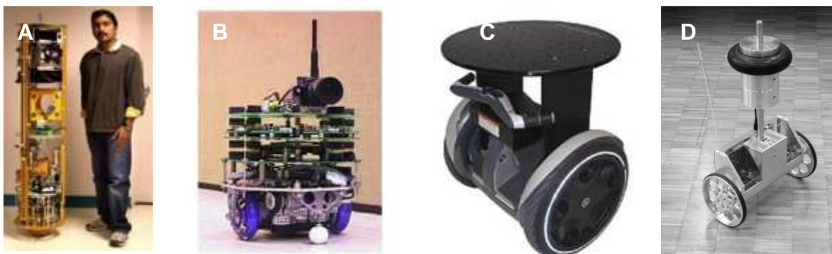
Figura 1 – Sistemas Auto-Equilibrantes: (A) Ballbot (LAUWERS et al., 2006); (B) nBot (NGUYEN et al., 2004); (C) Segway (NGUYEN et al., 2004); (D) JOE (GRASSER et al., 2002).
