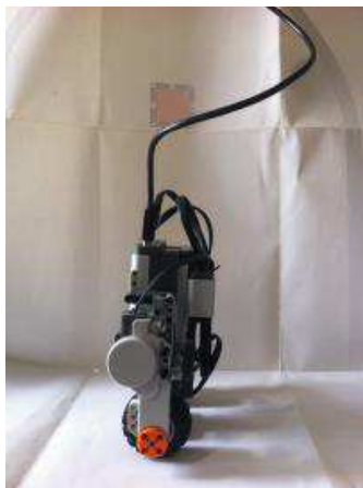
Figura 109 –Interferência do cabo de comunicação durante operação do NXT.
