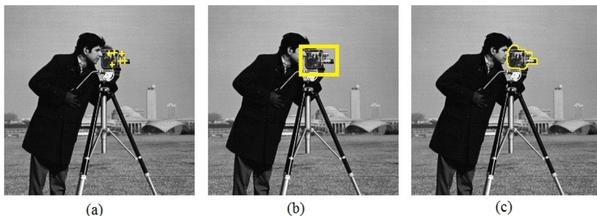
Figura 3: Exemplo de rastreamento para imagem "cameraman"(a) por pontos, (b) por kernel , (c) por silhueta
