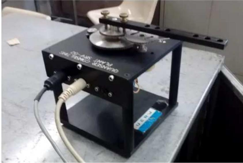
Figura 18 - Servomotor utilizado para implementação prática da estratégia.
