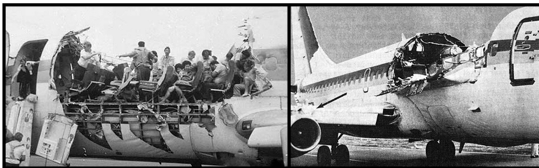
Figura 1 – Fotografias da aeronave Aloha Airline após ter tido parte da fuselagem separada por conta de fadiga mecânica adaptado de (AVIATION ACCIDENTS, 2016)
