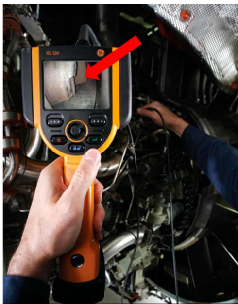
Figura 5 - Videoscópio modelo XL Go fabricado pela empresa GE adaptado de (DIRECT INDUSTRY, 2018)
