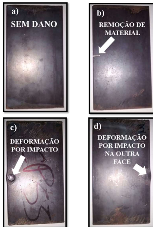
Figura 6 - a) Peça metálica referente à classe SD. b) Peça metálica referente à classe RMI. c) Peça metálica referente à classe DI. d) Peça metálica referente à classe DIPD
