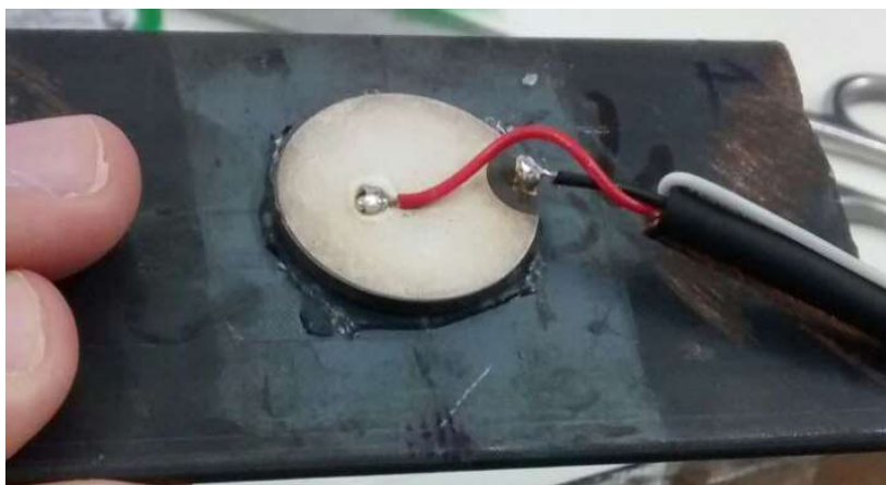
Figura 39 - Peça metálica fixada através da dupla face espessa cortada
