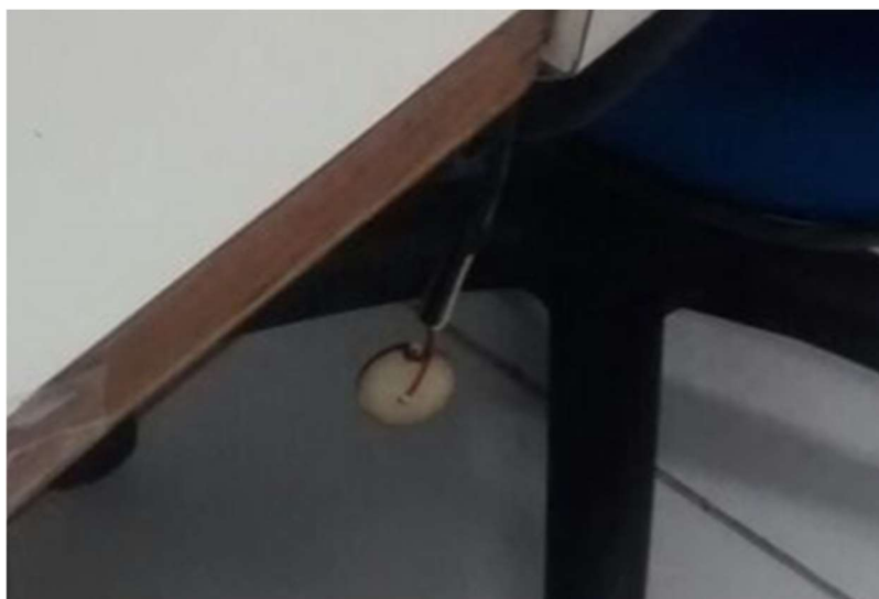
Figura 36 - PZT não fixado na peça metálica
