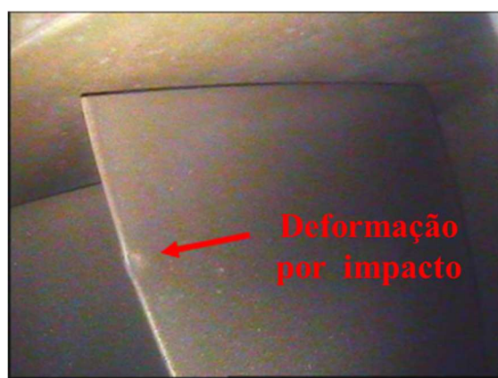
Figura 3 – Palheta com dano por conta do impacto de um objeto estranho adaptado de (SOBRINHO, 2013)
