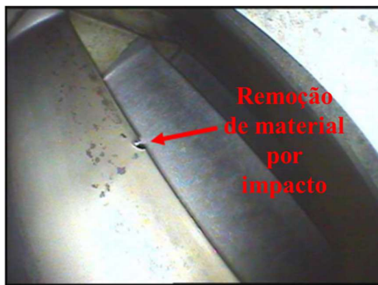
Figura 4 – Palheta com material removido por conta de impacto de um objeto estranho adaptado de (SOBRINHO, 2013)
