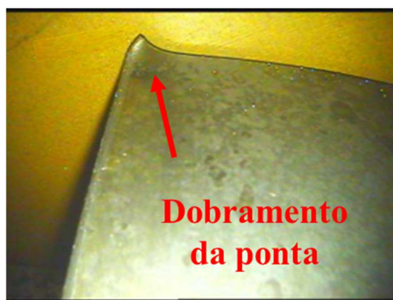
Figura 2 - Dobramento da ponta da palheta devido ao atrito contra a carcaça da máquina adaptado de (SOBRINHO, 2013)
