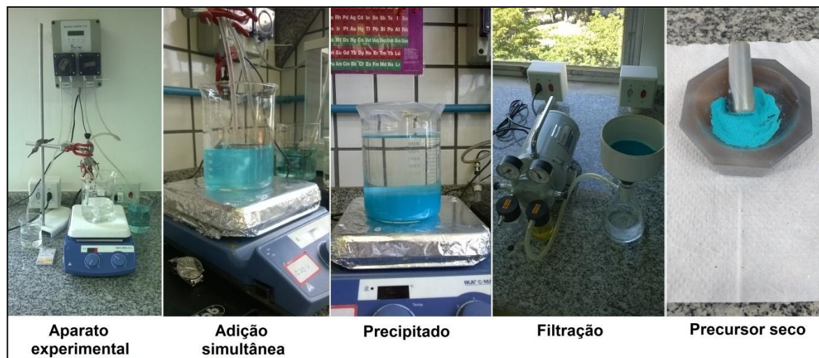
Figura 12 – Etapas experimentais de preparo do precursor tipo hidrotalcita (CuAl-HT)
